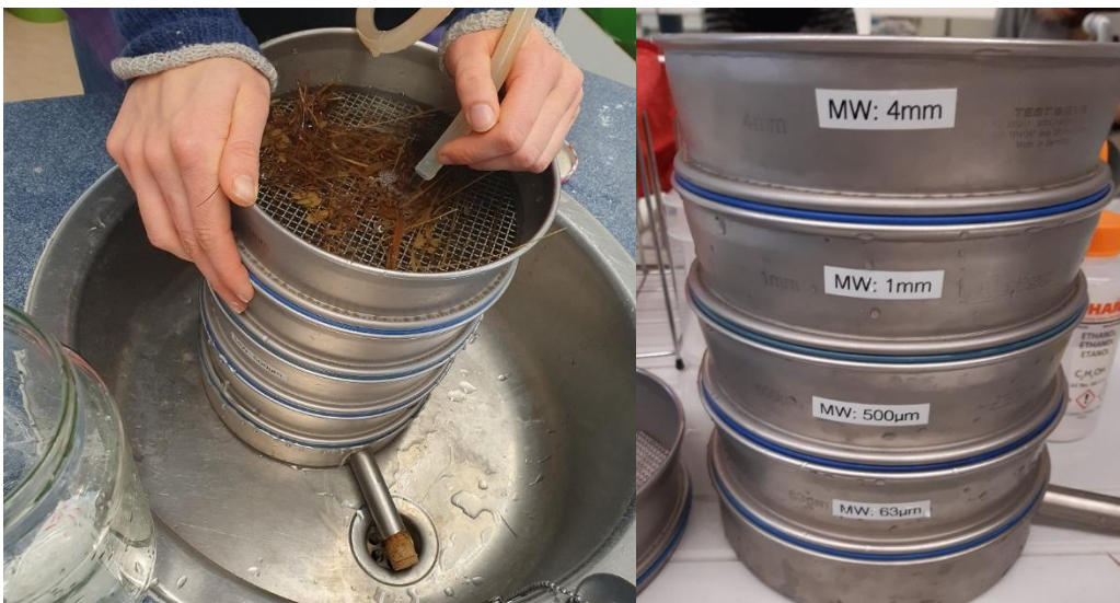
Abb. 20: Reinigen und Sortieren einer Probe mit dem Siebturm
