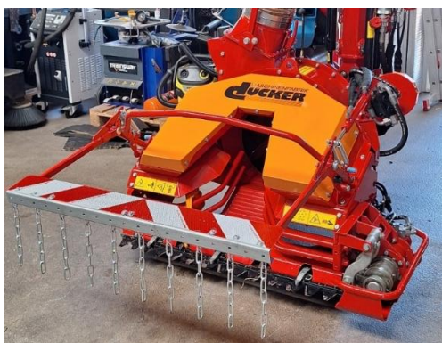
Abb. 38: Dücker SGG 1200 (Frontansicht mit Insektenscheuche)
