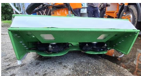
Abb. 3: Mulag ECO 1200 plus. Sichtbare biodiversitätsschonende Massnahmen: Insektenscheuche (Plastikplane, im eingefahrenen Zustand), Scheibenmähwerk, geschlossener Gehäuseboden
