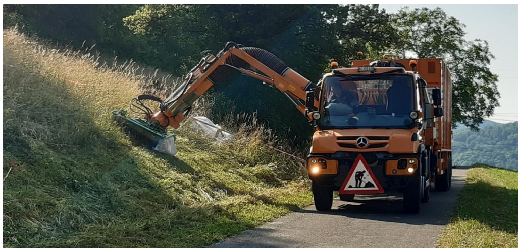
Abb. 11: Ökomäher Mulag Eco 1200 plus bei der Mahd
