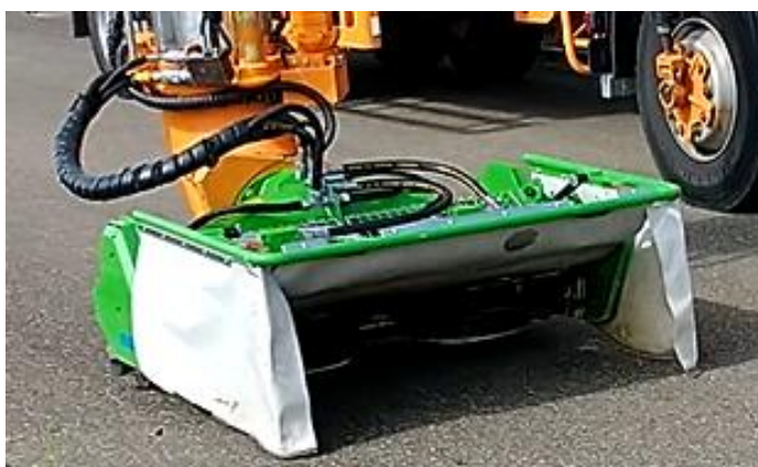
Abb. 48: Mulag Eco 1200 plus mit eingeschalteter Absaugvorrichtung. Die Kunststoffplane der Insektenscheuche wird deutlich nach innen gesaugt
