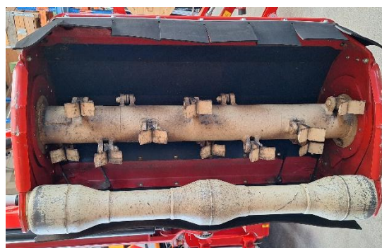
Abb. 4: Dücker Öko 1200 plus. Sichtbare biodiversitätsschonende Massnahmen: Mulchmähwerk mit Y-Messern, Tastwalze mit Verjüngungen
