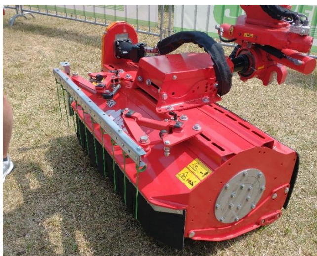
Abb. 37: Dücker VSM 1200 Öko mit eingeklappter alternativer Insektenscheuche mit Metallstriegeln
