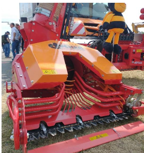
Abb. 1: Dücker SGG 1200. Sichtbare biodiversitätsschonende Massnahmen: Balkenmähwerk, mechanische Schnittgutbeförderung, Absaugvorrichtung
