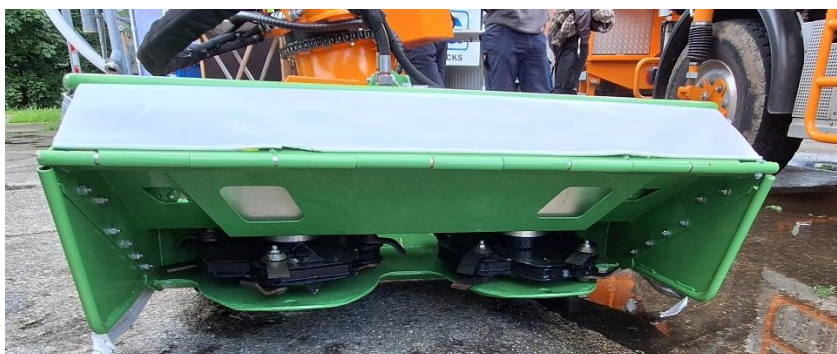
Abb. 33: Mulag ECO 1200 plus, Frontansicht mit eingeklappter Insektenscheuche
