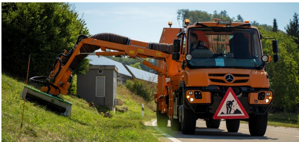
Abb. 6: Unimog bei der Mahd einer Strassenböschung mit dem Ökomähkopf Mulag Eco 1200 plus. Bild: Kaspar Kluth
