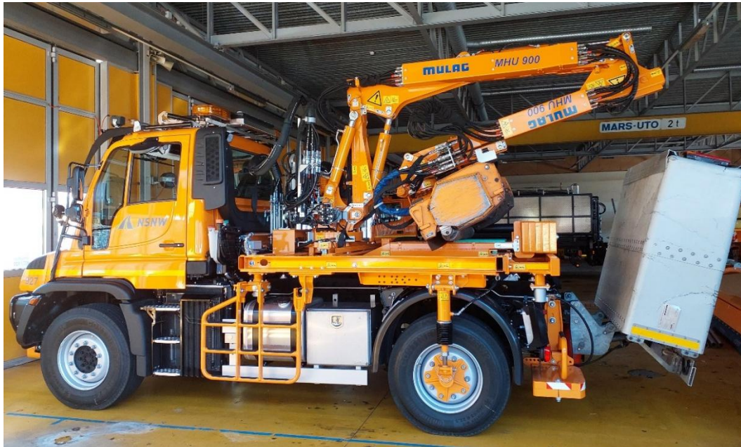
Abb. 9: Schlegelmulcher Mulag MK 1200 Plus auf Unimog
