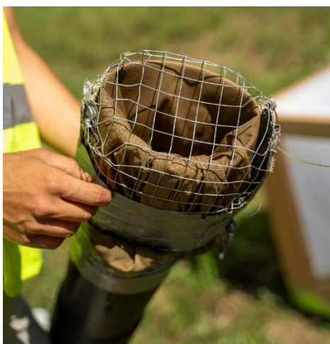
Abb. 17: Saugstutzen des Laubsaugers mit Drahtgitter und Fangnetz
