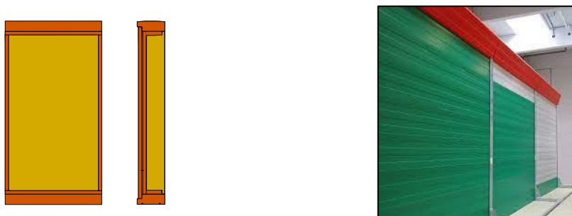
Abbildung 15: Skizze von Vorder- und Seitenansicht (links) der untersuchten LSW aus Schilf (ockerfarbener Bereich) und Holz (braunfarbiger Bereich) sowie LSW-Prüfstand des AIT (rechts, Symbolbild).
