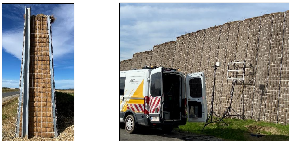
Abbildung 19: Seitenansicht eines Steilwalls an der Schnellstraße S7 (links) und durchgeführte Schallreflexionsmessung an exemplarisch untersuchtem Steilwallabschnitt (rechts).
