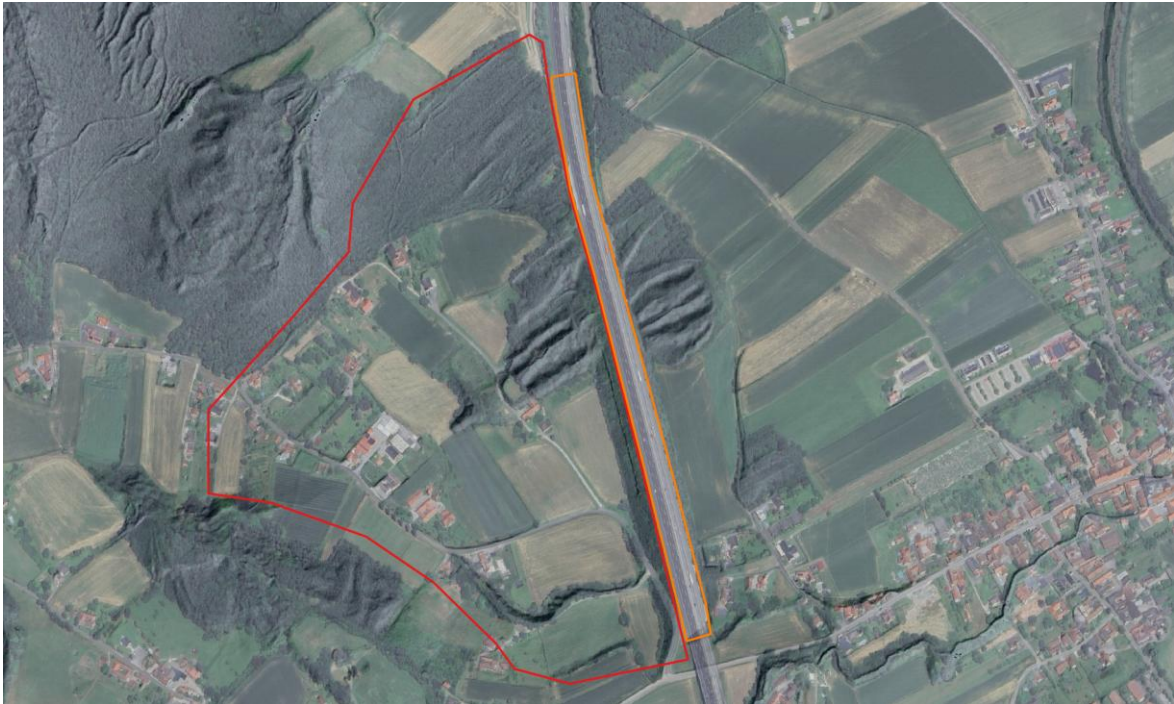
Abbildung 28: Einzugsgebiet für Starkregensimulation, Rot = Berechnung des Vorlandes, Orange = Berechnung der Autobahnflächen.
