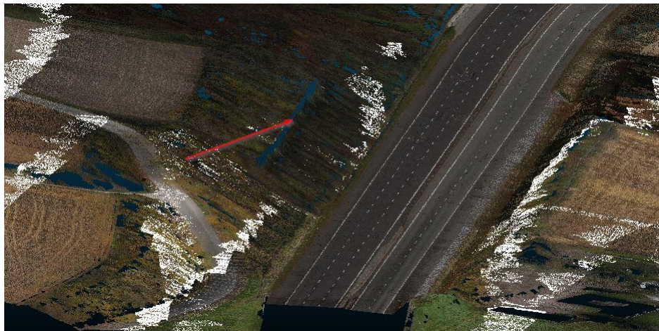
Abbildung 24: Kolorierte Punktwolke des Projektgebietes – Roter Pfeil: Herausgefilterte Stützmauer im Nahbereich der Autobahn.
