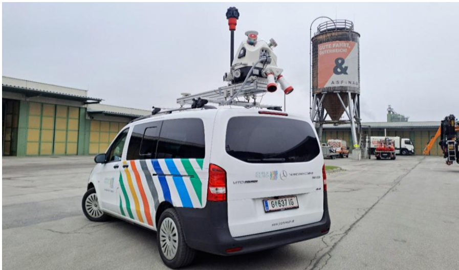
Abbildung 6: Messfahrzeug mit montiertem MLS in Basiskonfiguration inkl. Pavement-Kameras
