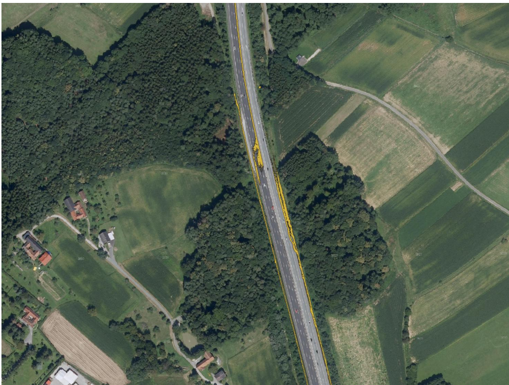
Abbildung 36: Überflutungsflächen durch Starkregen auf Autobahn - Simulationsstufe 3 (100-jährlich / 30- minütiges Starkregenereignis)
