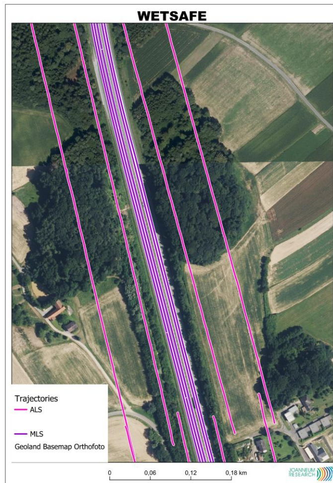
Abbildung 9: Detailansicht der Trajektorien der eingesetzten Messsysteme auf bzw. entlang der A2-Südautobahn. Die Trajektorie des MLS ist violett und die des ALS pink dargestellt.
