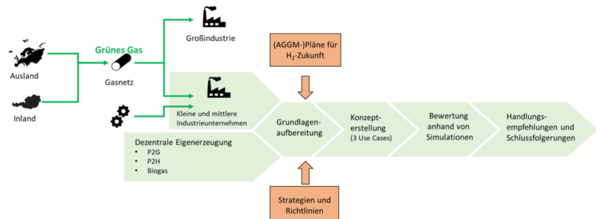
Abbildung 4: Vorgangsweise im Rahmen von Gas Switch
