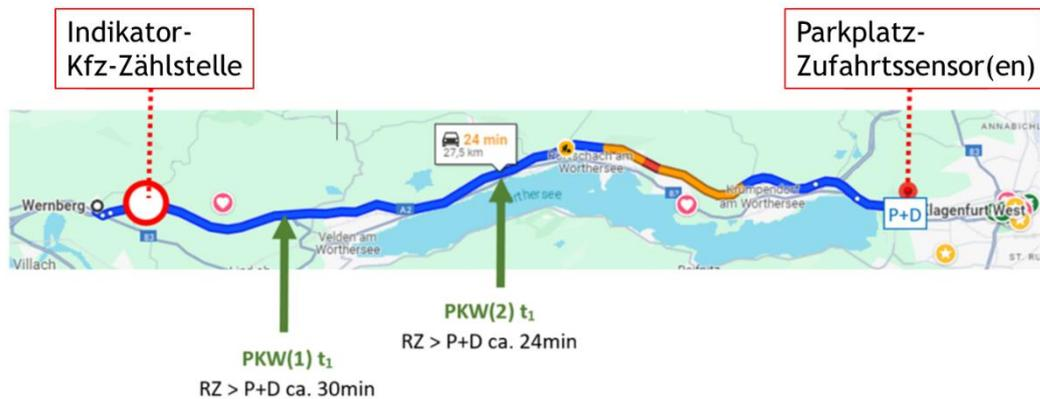
Abbildung 5-6: Übersicht Prognosemethode mit Indikator-Kfz-Zählstelle (Realtime) und Parkplatzbesetzung (Realtime), Beispiel zwei zufahrende PKW mit unterschiedlichen Restzufahrtszeiten
