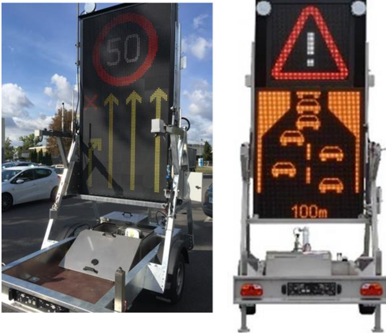
Abbildung 19: Exemplarische Darstellung eines mobilen Stauwarnanhängers
