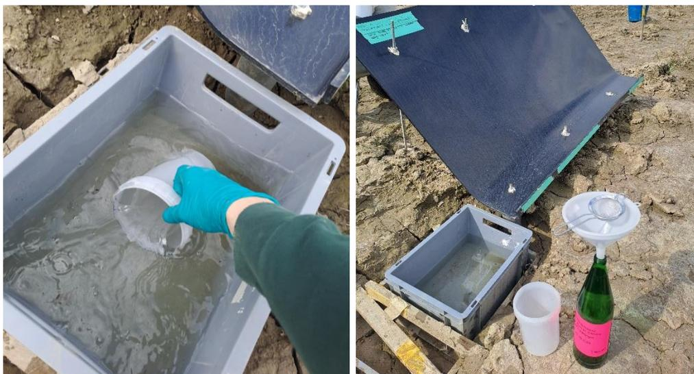
Abbildung 25: Durchmischung des Inhalts der Gischtfänger-Auffangbox (links) und Transfer über Trichter in Sieb in etikettierte Probeflasche (rechts)
