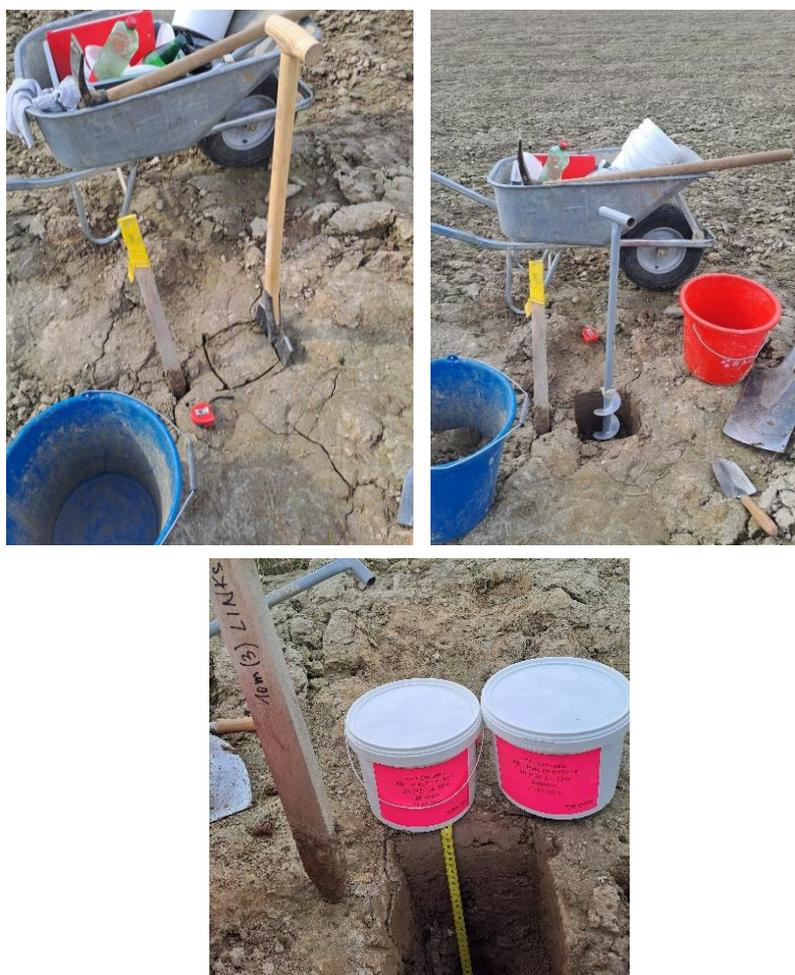
*Abbildung 22: Darstellung der Bodenprobenahme. Aushub des ersten Bodenhorizontes (0 – 20 cm) mittels Spaten und Transfer in blauen Kübel (oben links); Fortsetzung ab einer Tiefe von 20 cm mit händischem Drillgerät und rotem Kübel für Boden von 20 – 40 cm (oben rechts); entnommenes Material in Probenahmegebünde (unten)*
