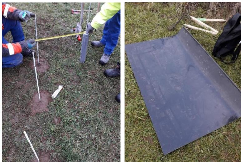
*Abbildung 18: Aufbau des Gischtfängers: Vergraben der Gewindestangen (links) und Auffangplatte (rechts)*
