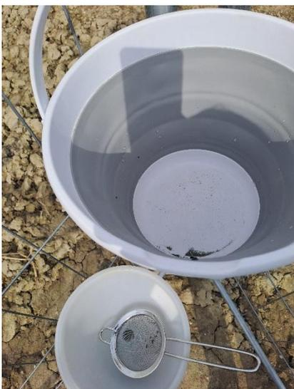
Abbildung 24: Regenfänger mit sichtbaren Verunreinigungen
