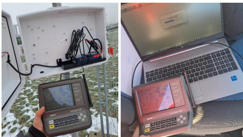
Abbildung 26: Solarpaneel und Aufbewahrungsort der Konsole von innen (links) und Vor-Ort-Auslesen der Wetterdaten (rechts)
