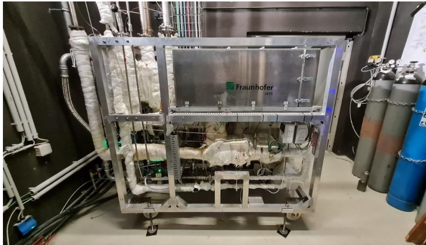
Abbildung 9: Rahmenstruktur - rSOC-System im Fuel Cell Lab in Pinkafeld
