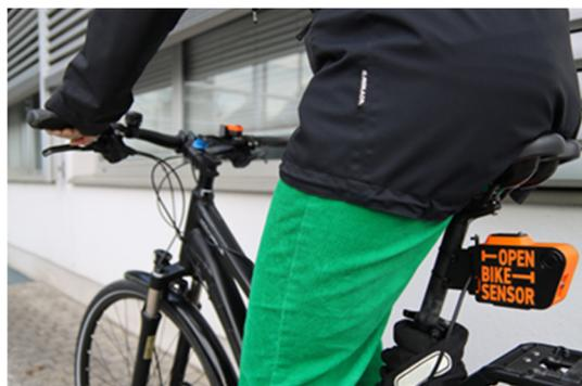
**Abbildung 23: Ausgehend von der Sattelstütze und abzüglich der halben Lenkerbreite sowie des Außenspiegels des Kfz misst der OBS den Seitenabstand nach rechts und nach links**
