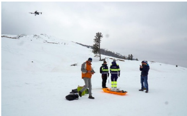
Abbildung 22 Radarintegration, Testgebiet am Dobratsch (Rostratte) und Messschlitten zur bodenbasierten Radarmessung
