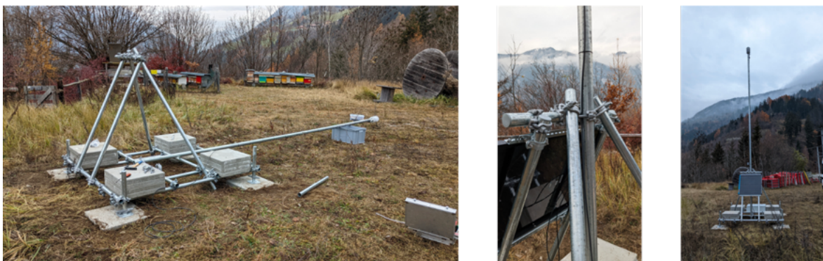
Abbildung 43 Konstruktion der autarken Messstation
