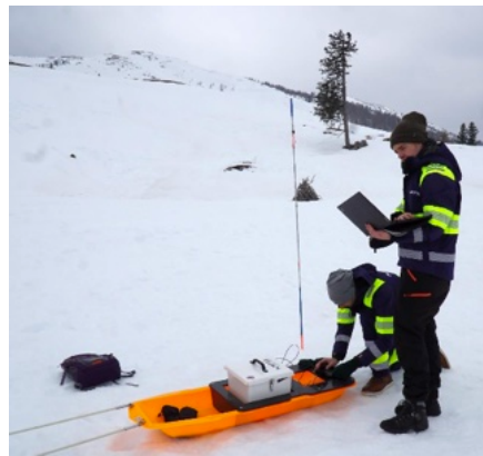
Abbildung 22 Radarintegration, Testgebiet am Dobratsch (Rostratte) und Messschlitten zur bodenbasierten Radarmessung
