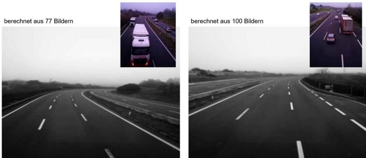
**Abbildung 28: Generierung Bild der Fahrbahn ohne Verkehr durch Mittelung einer Serie von Einzelbildern.**
