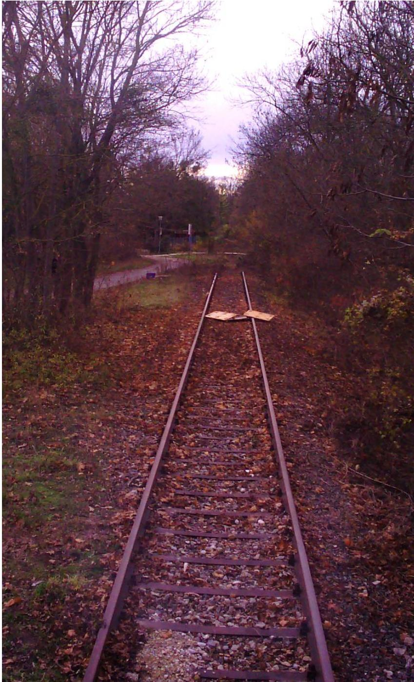
**Abbildung 45:Objekttest Blumau „Verschüttung“, Entfernung zum Sensor 30m**
