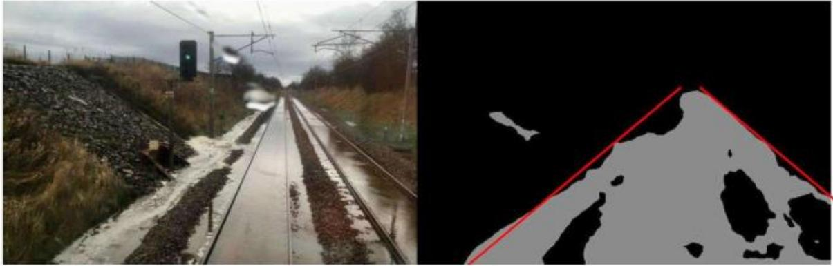
**Abbildung 12: Beispiel für die Identifikation eines überfluteten Bereiches aus Kameraaufnahme (Quelle: Software Competence Center Hagenberg).**
