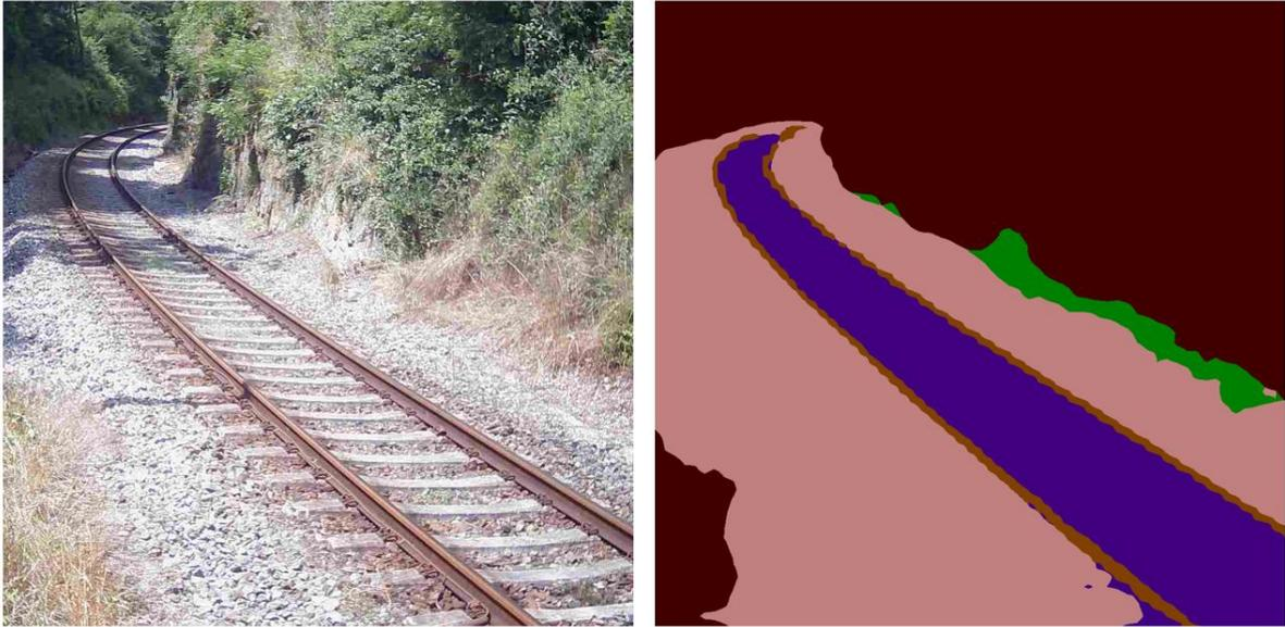
**Abbildung 24: Ablauf der Anomalie-Erkennung basierend auf der Bildsegmentierung und synthetisierten Vergleichsbildern.**
