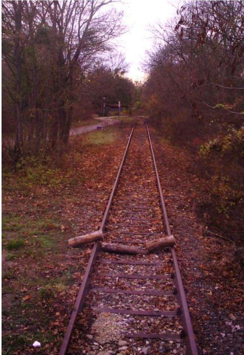
**Abbildung 44: Objekttest Blumau Holzstämmen, Entfernung zum Sensor 10m**
