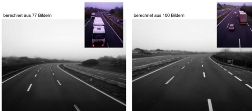
ABB 2. Medianbildergenerierung zur Anomalieerkennung am Beispiel ASFINAG
