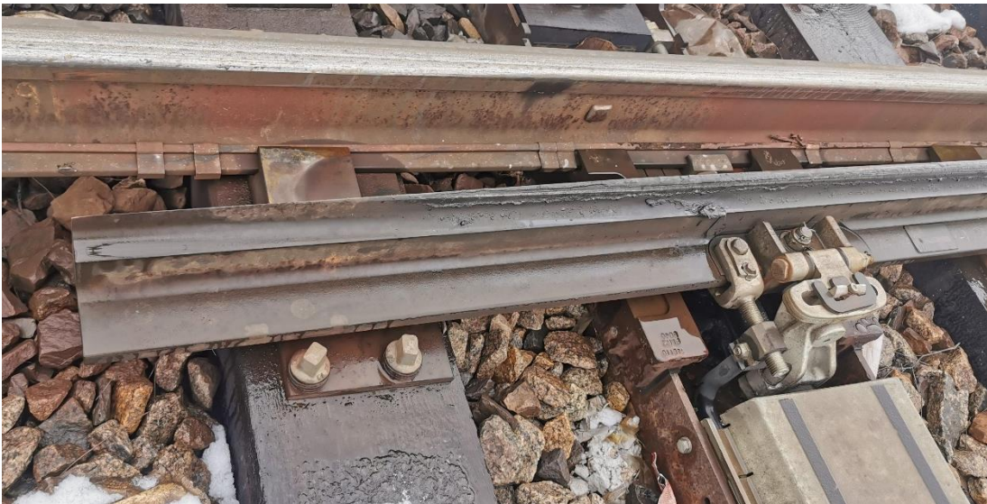
Abbildung 3: Verschleiß bei der Zungenspitze (Bildquelle: AC2T research GmbH)
