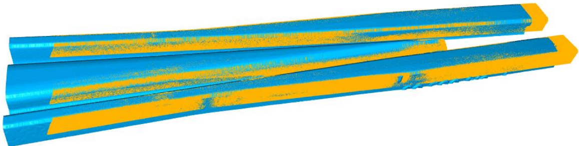
Abbildung 30: Nach Minimierung der Z-Komponenten zwischen den korrespondierenden Punktpaaren im Definitionsbereich (gelb: vermessenes Objekt, blau: Referenzobjekt)
