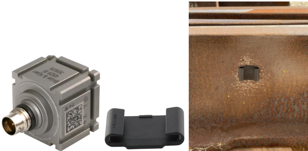
Abbildung 34: Beschleunigungssensor, Befestigungsklemme 13 und Positionierung am Herzstück (15 cm hinter der praktischen Herzstückspitze; die vertikale Position befindet sich ca. in der Mitte des Herzstückes; siehe auch Abbildung 64)
