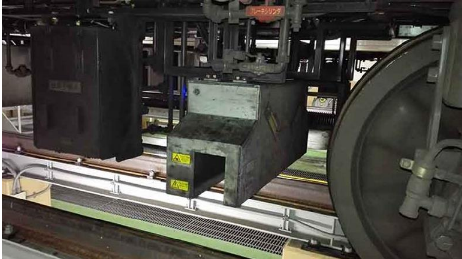
Abbildung 7: Schienenmesssystem der Firma Omnicom 5
