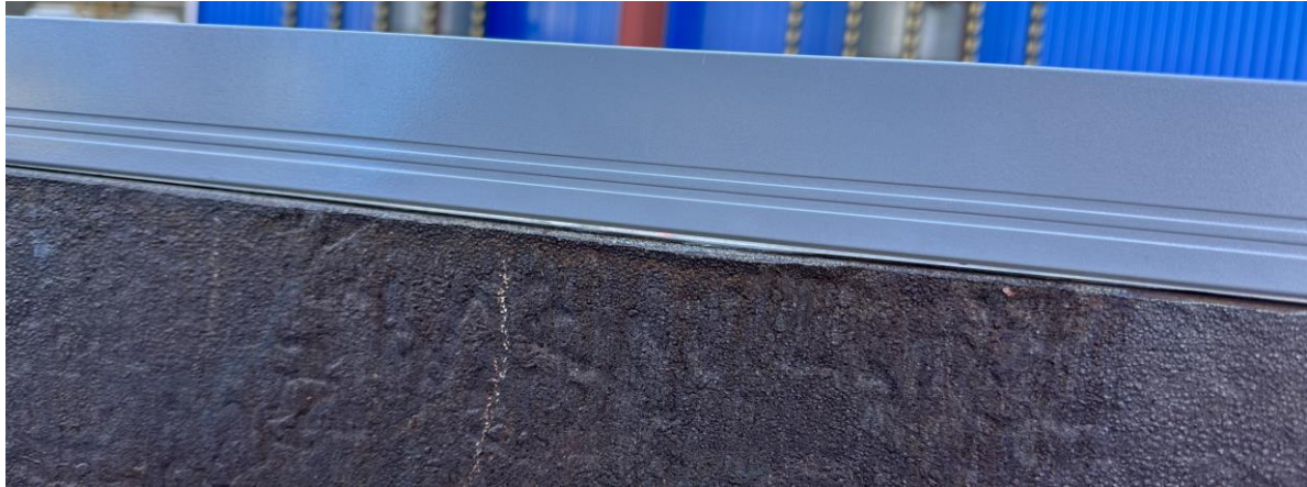
Abbildung 19: Reale Durchbiegung eines Weichenherzstücks im Vergleich zur Messlatte
