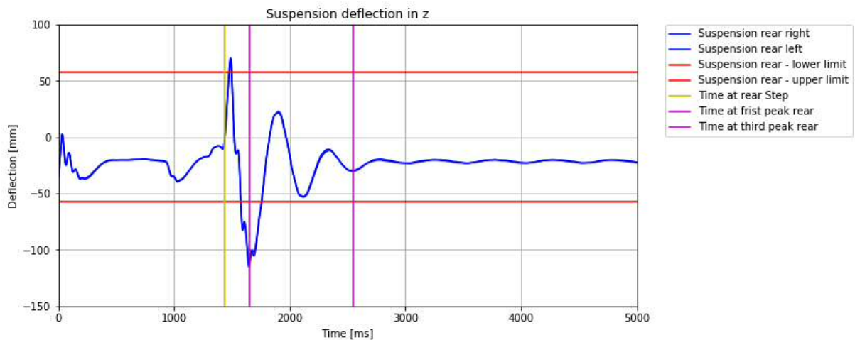
Abbildung 30: 3.3: Stufenfahrt – Federweg der hinteren Radaufhängung
