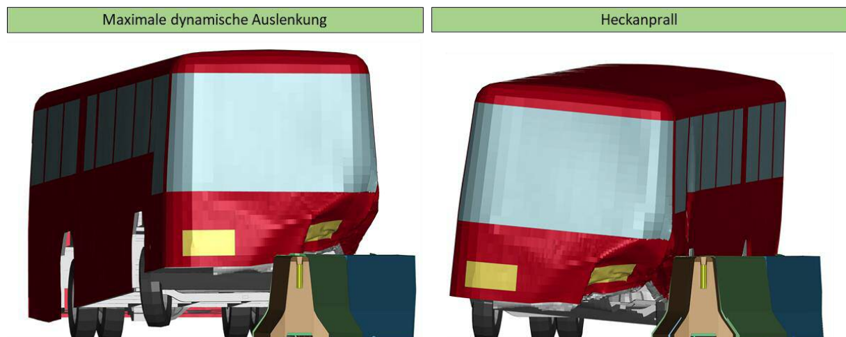
Abbildung 81: Kinematik bei TB51 Anprall an die ÜK KB1 RH2 – DB100 6m – Frontansicht
