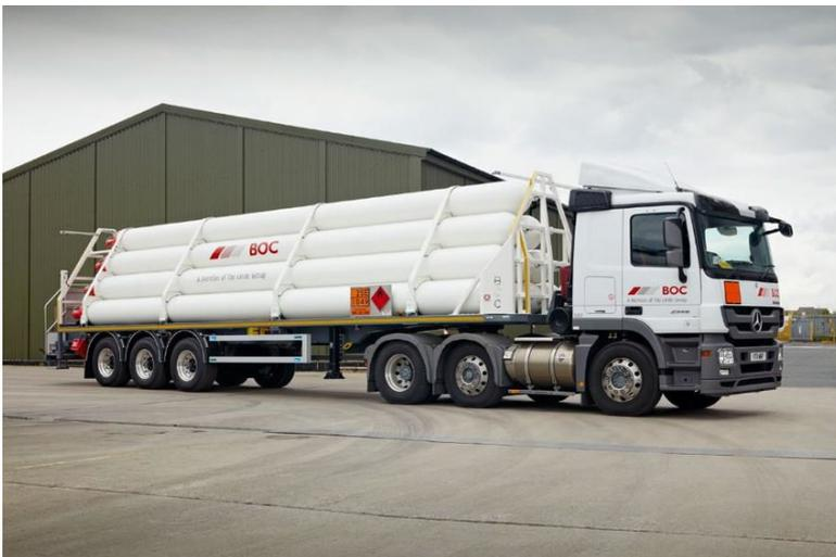
**Abbildung 3: Röhren bzw. Tube-Trailer [4]**
