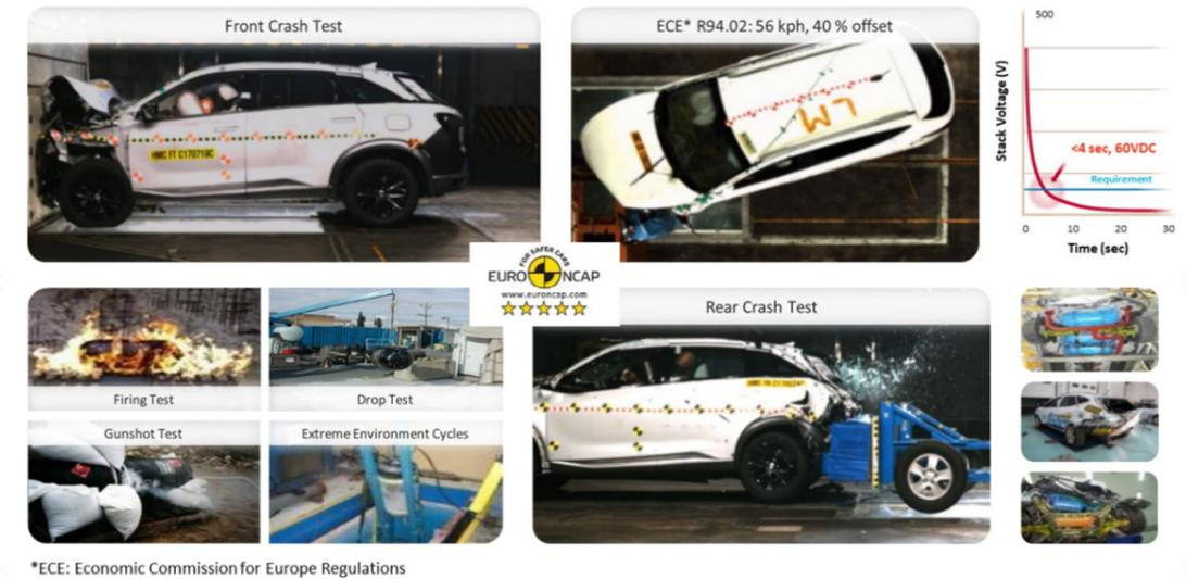
Abbildung 45: Crashtest und Behälter Tests des Hyundai Nexu [35]
