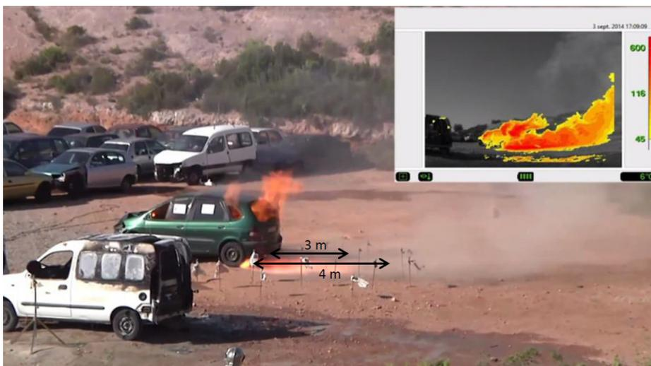
**Abbildung 7: PKW mit gasförmigem H<sub>2</sub>-Speichersystem in Brand [9]**
