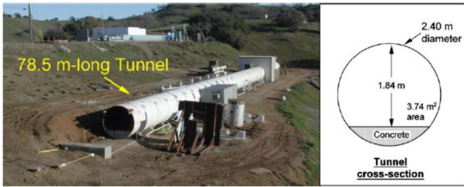
**Abbildung 15: Versuchstunnel im Maßstab 1:5 zur Durchführung von Deflagrations- und Detonationsversuchen [13]**
