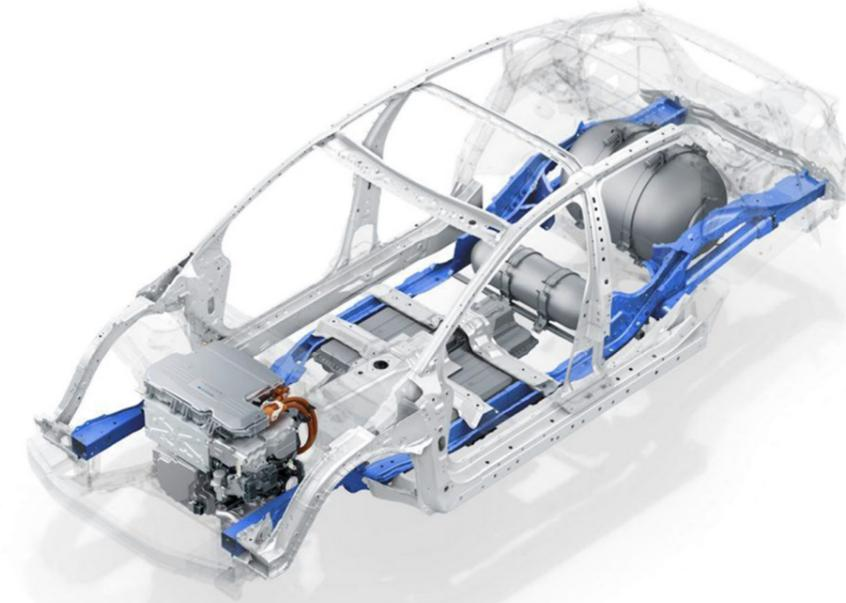
Abbildung 47: Strukturelle Verstärkungen des Chassis für erhöhte Sicherheit gegen Verformung für das HSS [24]
