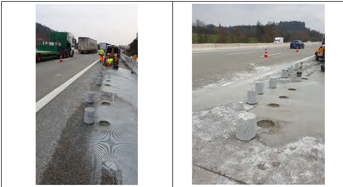
Abbildung 75: Exemplarische Bohrkernentnahme auf der BAB A9 RF Berlin (links) und auf der BAB A9 RF Nürnberg (rechts).
