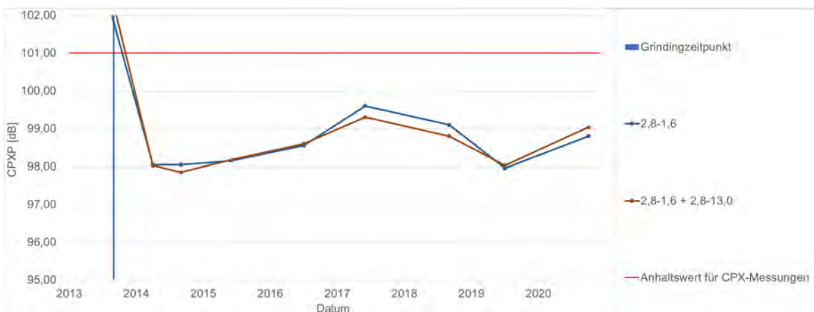
Abbildung 23: Zeitlicher Verlauf der Reifen-Fahrbahn-Geräusche (CPX) auf der A93 Luhe-Wildenau, RFB Regensburg
