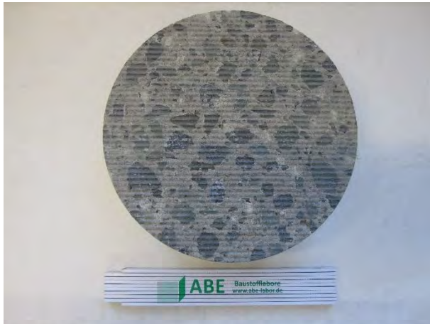
Probekörper 10-4 vor Frost-Tausalz-Beanspruchung
