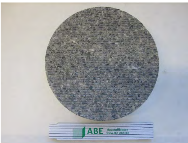
Probekörper 11-3 vor Frost-Tausalz-Beanspruchung
