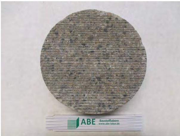
Probekörper 8-HFS-2 vor Frost-Tausalz-Beanspruchung
