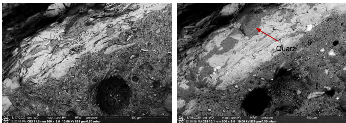
Abbildung 51: Gesteinskorn (Amphibolit) in einem Steg nach 500 Überrollungen (links) und nach 270.000 Überrollungen (rechts; mit rotem Pfeil markierter Quarz wurde freigestellt, der Zementstein in der unteren Bildhälfte wurde deutlich tiefergelegt).
