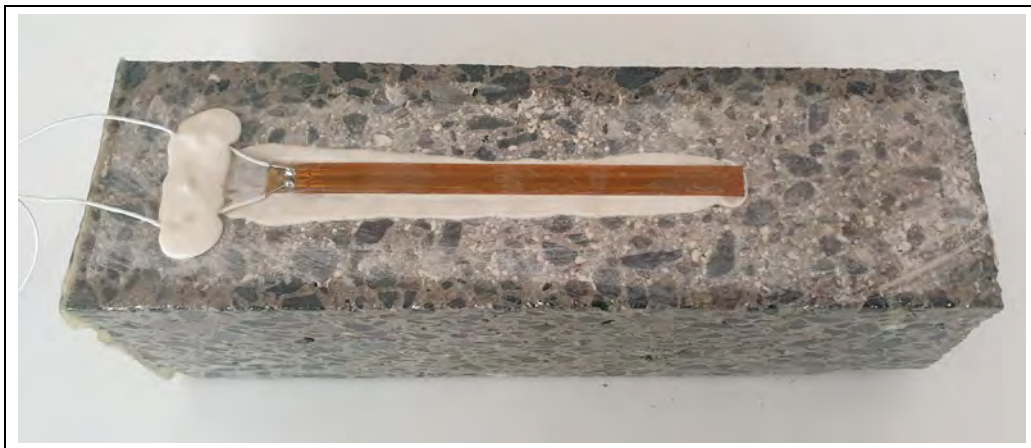
Abbildung 76: Bestimmung der Wärmedehnzahl mit DMS
