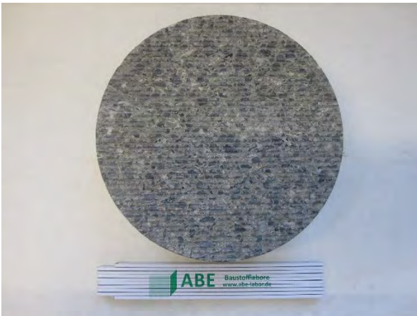
Probekörper 11-2 vor Frost-Tausalz-Beanspruchung
