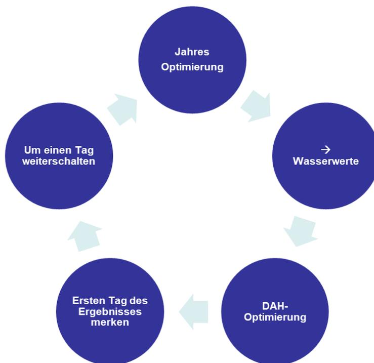
Abbildung 29: Ablauf Rollierung: Beim Backtesting des Kalenderjahres 2021 wird mit der Jahresoptimierung vom 01. Jänner 2021 gestartet und es endet mit der DAH-Optimierung vom 31.12.2021.
