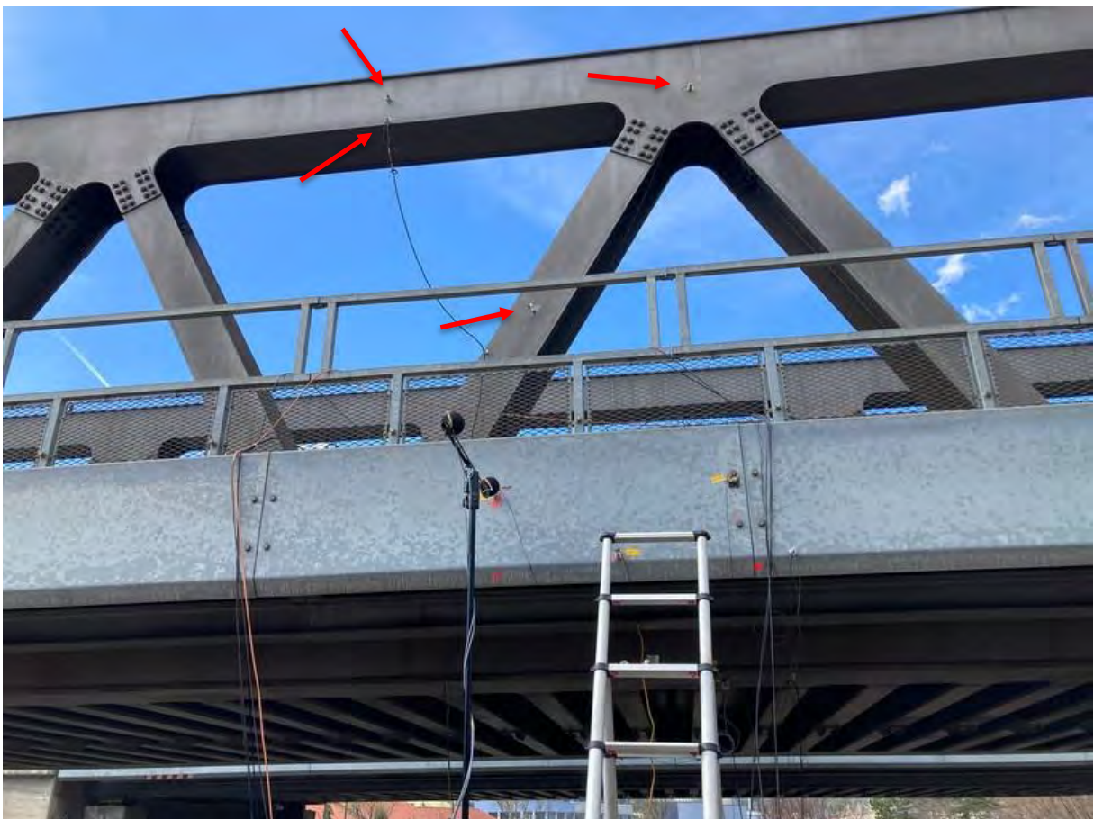
Abbildung 23: Messquerschnitt 2 mit Beschleunigungssensoren a 8 bis a11.
