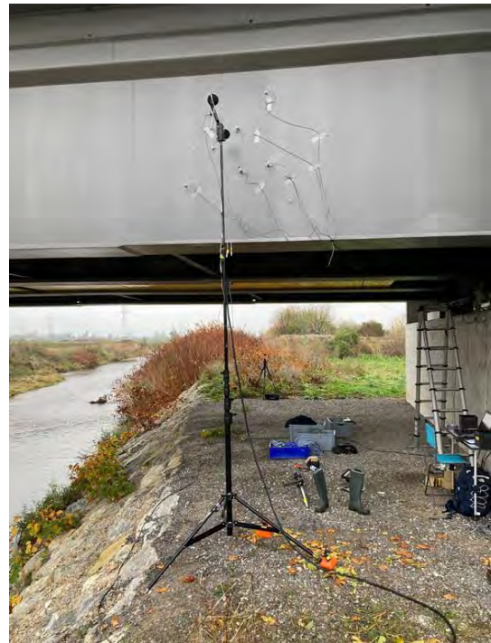
Abbildung 9: Beschleunigungssensoren a7 bis a12 am Blech P2.
