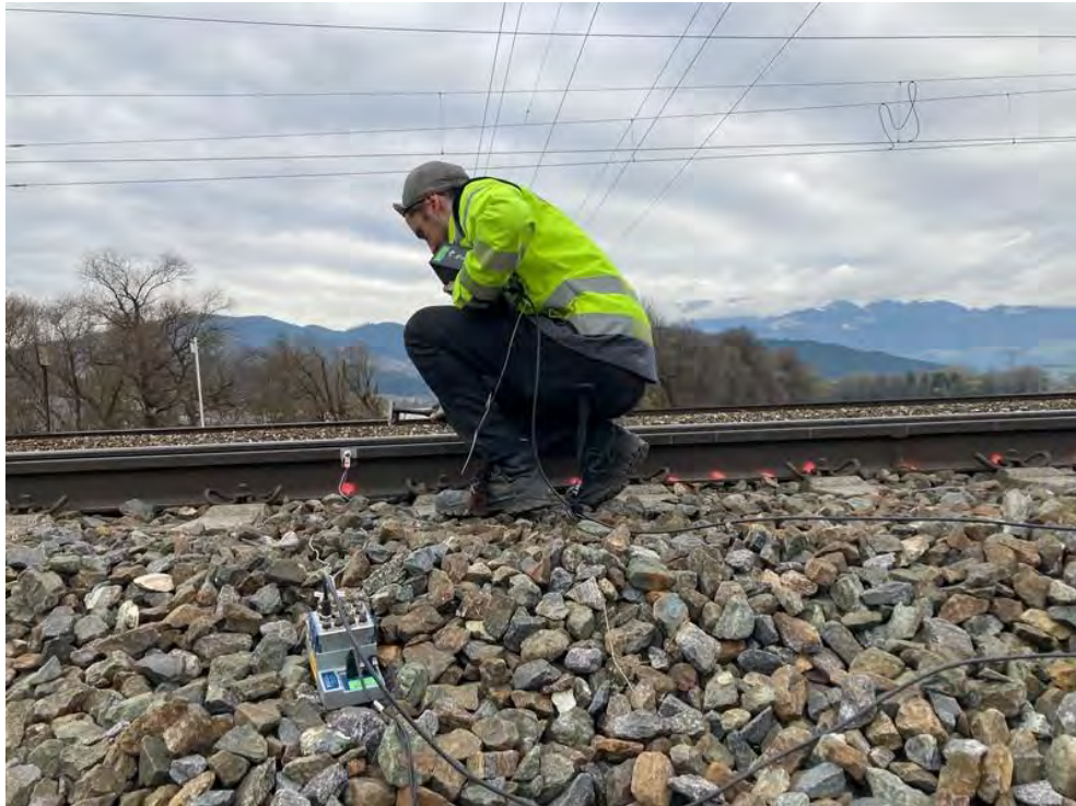
Abbildung 88: Messung mit Impulshammer auf der Freien Strecke.
