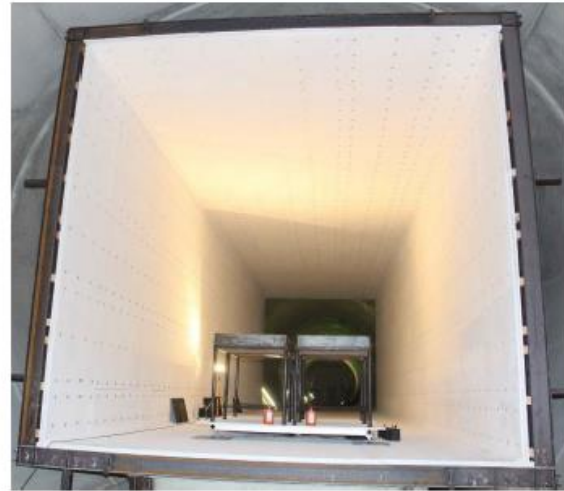
Abbildung 2-2: Einhausung des Brandortes mit Brandschutzplatten
