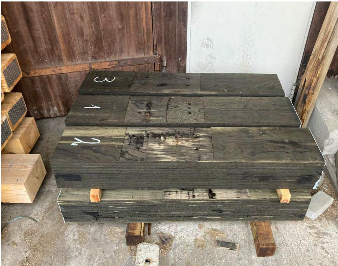
**Abbildung 52: Mit HSM 1 imprägnierte Furnierschichtholzschwellen nach 10-wöchiger Freilufttrocknung**
