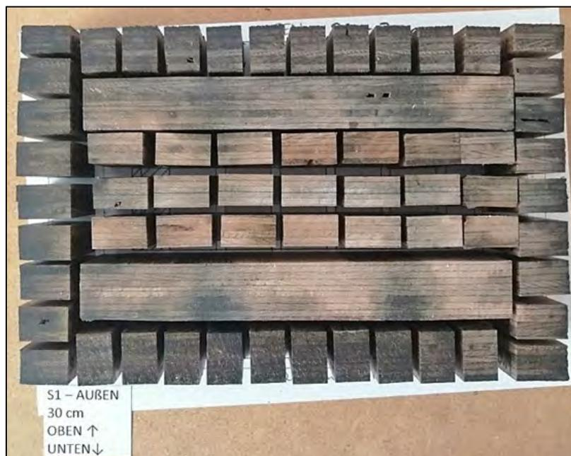
Abbildung 59: Prüfkörper aus Schwellensegment mit Abmessungen von  $(15 \times 25 \times 50) \text{ mm}^3$  für Dauerhaftigkeitsprüfungen in Anlehnung an EN 113-2 (2021).
