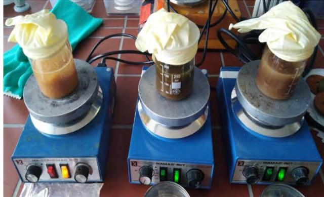
**Abbildung 5: Schütteln der Fasern auf Rührplatten unter Luftabschluss**
