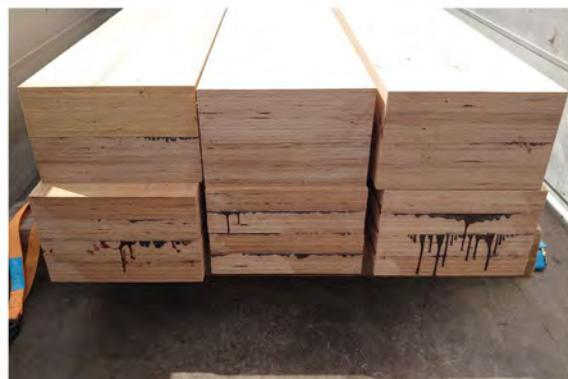
**Abbildung 49: Herstellung der Halbschwellen**
