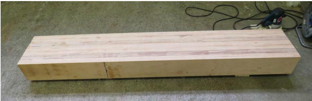
**Abbildung 9: Prototyp einer Buchenfurnierschichtholzschwelle aus blockverklebten Furnierschichtholzplatten**
