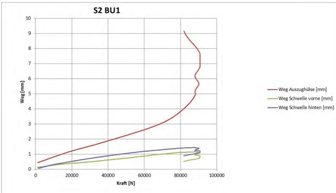
**Abbildung 44: Exemplarische Schraubenverschiebung einer kreosotimprägnierten Buchenvollholzschwelle als Funktion der Kraft**
