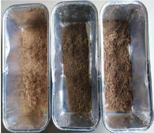
**Abbildung 4: Faserproben zur pH-Wertbestimmung**
