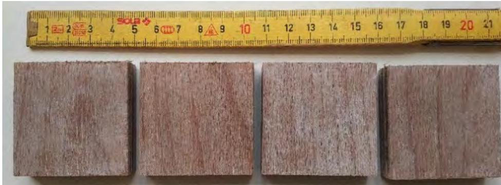
**Abbildung 3: Probenabschnitte einer zementimprägnierten Furnierschichtholzplatte**
