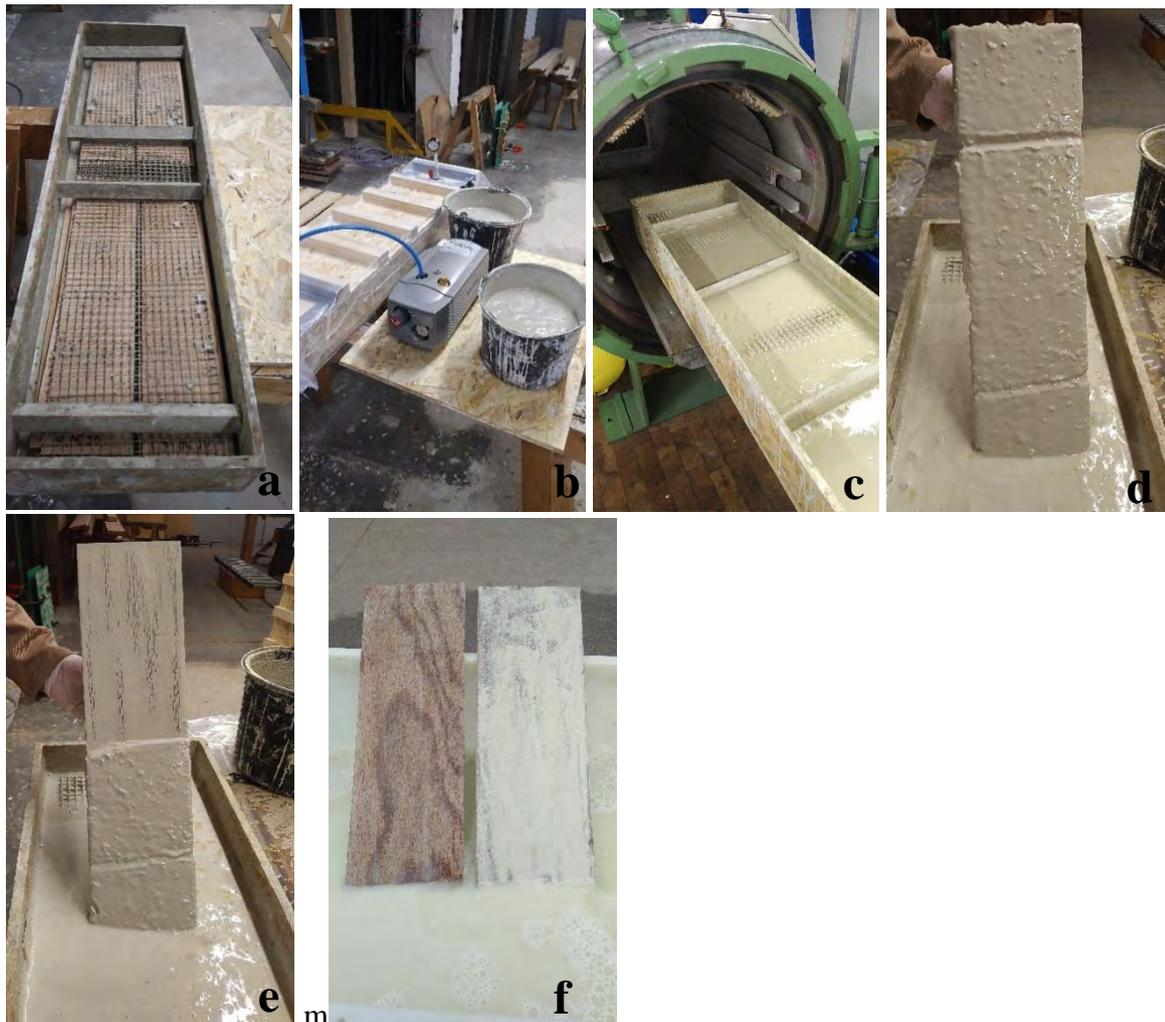
**Abbildung 1: Imprägnierprozess mit anschließender Trocknung: a) Einlegen der Furniere mit Abstandsgitter; b) Unterdruckphase mit Einsaugen der Suspension; c) Überdruckphase im Autoklav; d) Furnier nach Imprägniervorgang; e) Ablösen der Zementschicht; f) waschen der Furniere in Wasser;**
