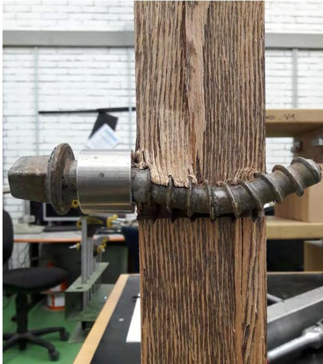
**Abbildung 48: Plastische Schwellenschraubendeformation bei einem zweischnittigen Lochleibungsversuch**
