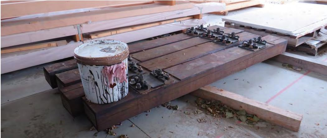
**Abbildung 8: Bahnschwellen für die Ermittlung der statischen Kennwerte für den Vergleich mit einer unbehandelten Buchenfurnierholzschwelle**
