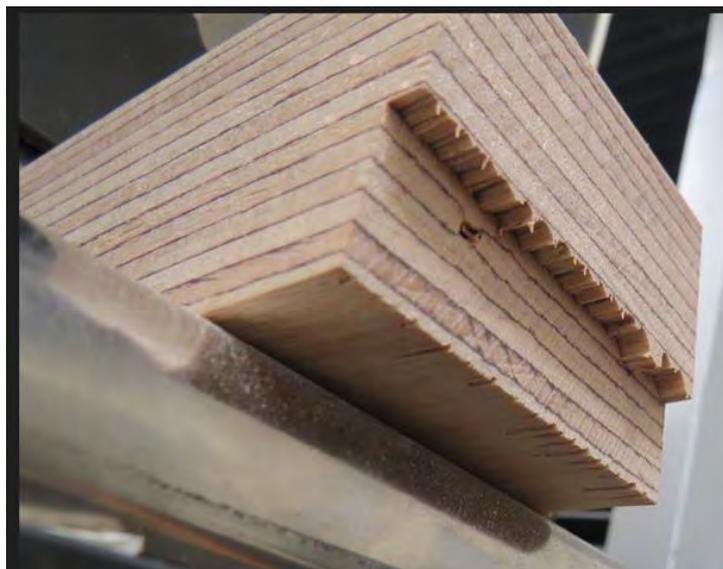
**Abbildung 90: Typisches Versagensbild: eindeutiges Schubversagen. Unbehandelter Prüfkörper. Bei allen Prüfkörpern verlief die Bruchfläche im Holz. Ein Versagen des Klebers konnte nicht nachgewiesen werden**
