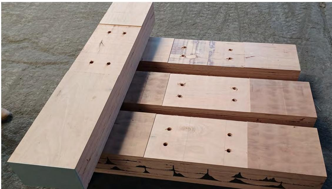
**Abbildung 51: Maschinell bearbeitete Halbschwellen vor der Imprägnierung**
