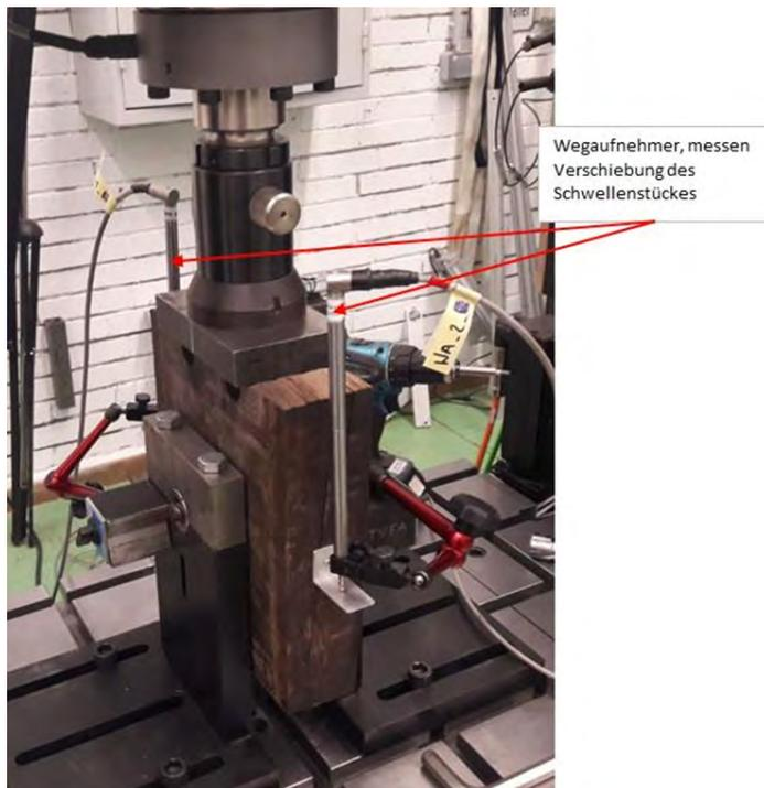
**Abbildung 16: Versuchsaufbau des zweischnittigen Lochleibungsversuches**
