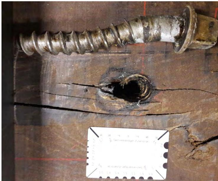
**Abbildung 42: Resultierendes "Schraubenloch" und Schraube nach einem Lochleibungsversuch**
