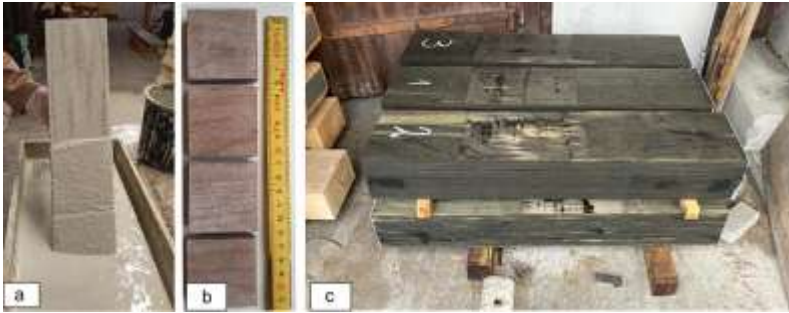
ABB 1. Darstellung a) des Herstellungsprozesses der zementimprägnierten Furniere, b) der verklebten Furniere zu FSH-Bauteilen und c) industriell zweistufig (wässrig und ölig) imprägnierte Bahnschwellen aus Furnierschichtholz.
