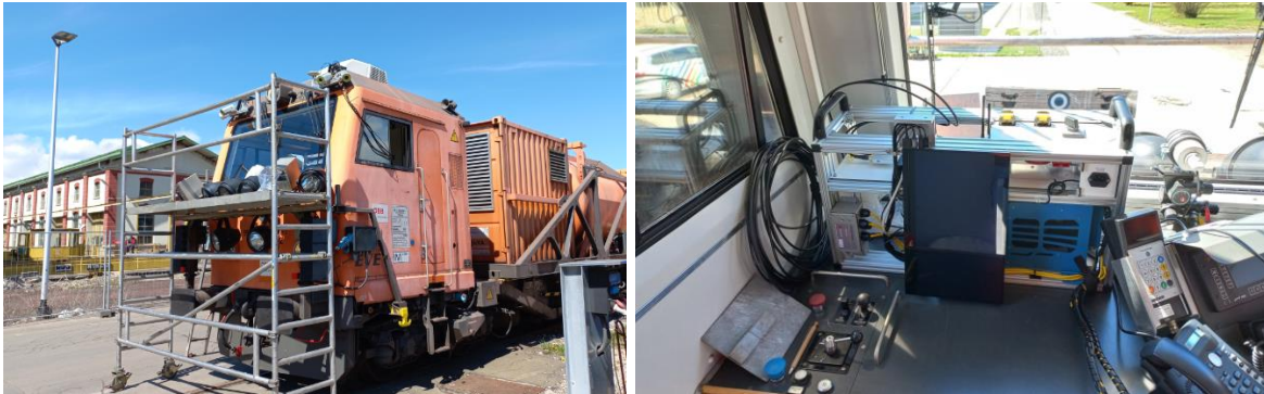
Abbildung 9: Montage des Aufnahmesystems für den Use Case Schiene. Kamerasystem auf der Lok, Aufnahmecomputer in der Lok.
