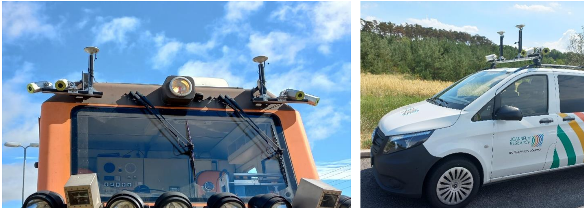
Abbildung 1: Montage des FloraMon Aufnahmesystemes auf Lok und Kleinbus/LKW
