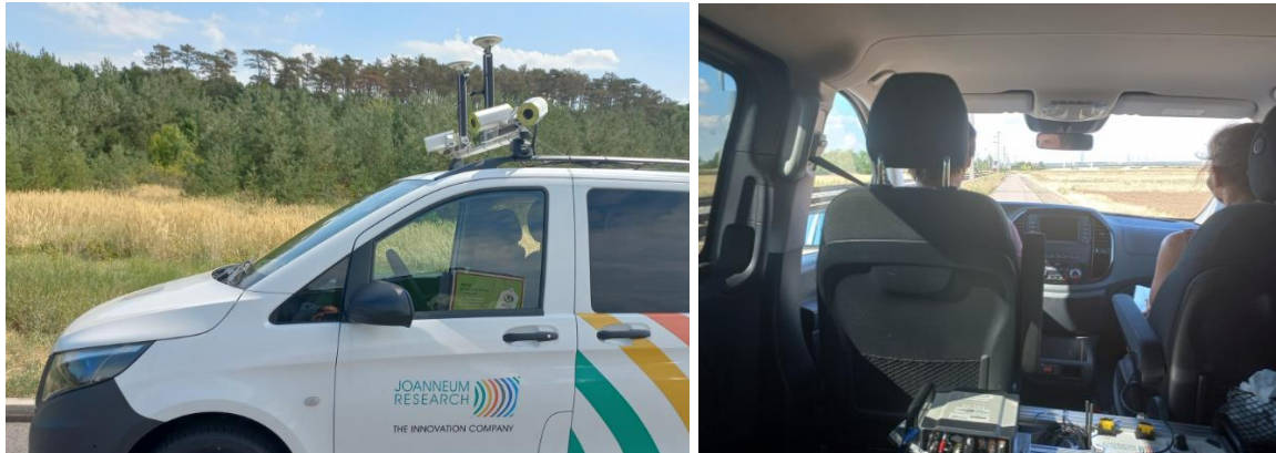
Abbildung 10: Montage des Aufnahmesystems für den Use Case Straße. Kamerasystem am Kleinbus, Aufnahmegeräte im Kleinbus.
