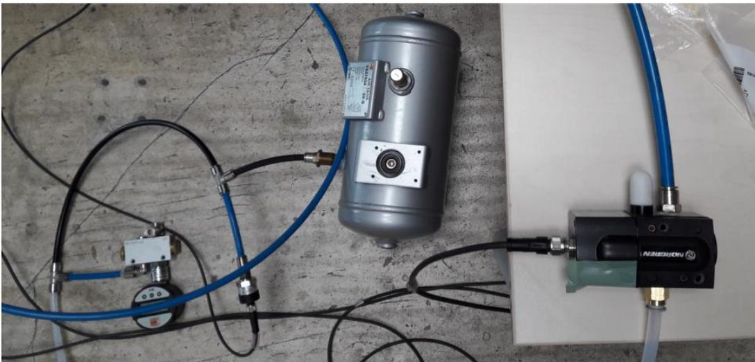
**Abbildung 18 Norgren LVP50 Druckregler mit angeschlossenem Drucktank**
