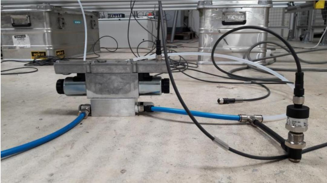
**Abbildung 14 Aventics ED07 Druckregler und Druckregler (rechts)**
