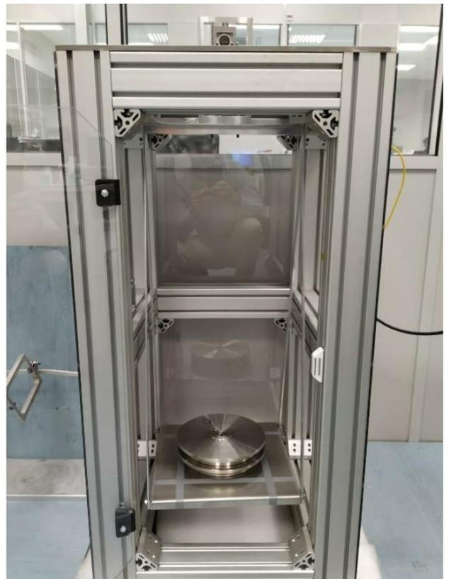
Abbildung 5 Testaufbau zur Prüfung der Kraftsensoren
