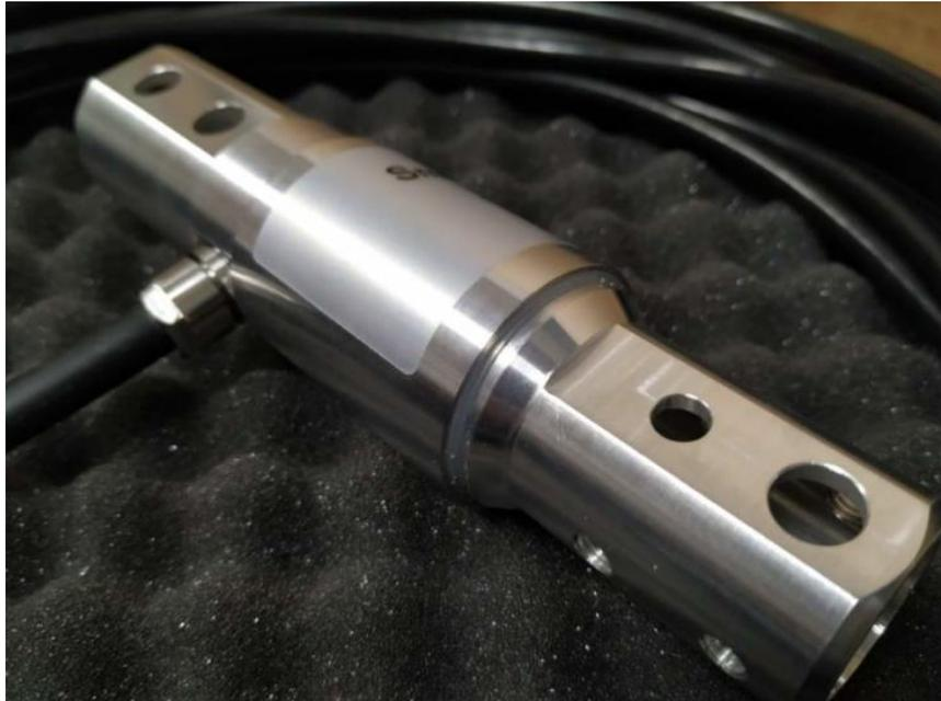
Abbildung 4 Abbildung des Kraftsensors
