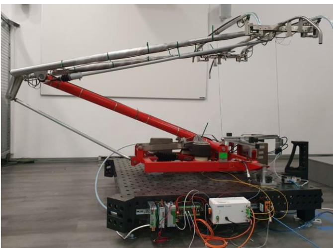
**ABB 1. Bild des mit Messtechnik ausgestatteten fertig aufgebauten Stromabnehmers, inkl. Komponenten im Wageninneren (unten im Vordergrund)**
