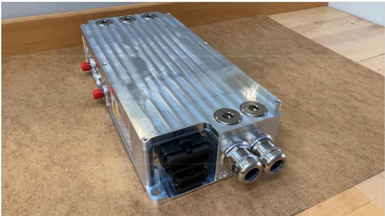
Abbildung 28 - IGBT-Inverter von Cascadia Motion
