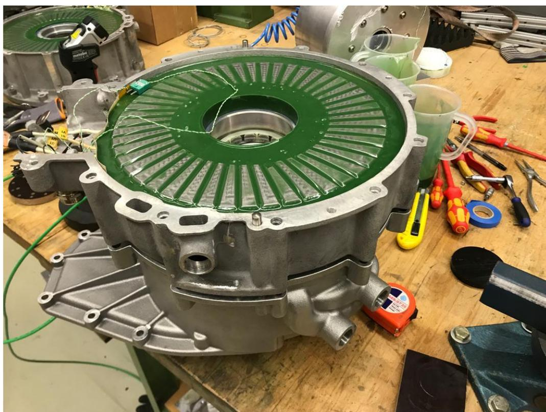
Abbildung 34 - AFM mit vergossenem Stator
