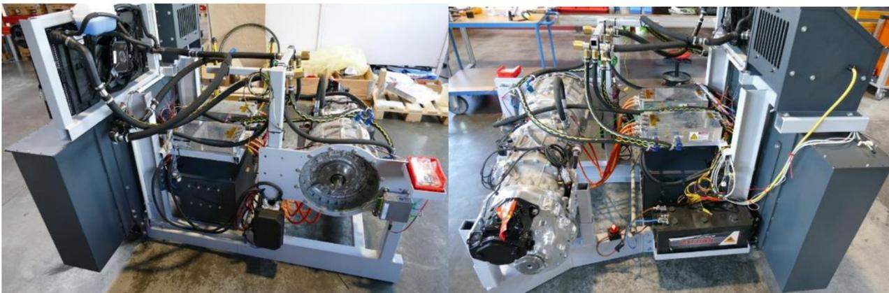
Abbildung 38 - eCVT-Antriebsstrang montiert auf Träger (Prüfrack)
