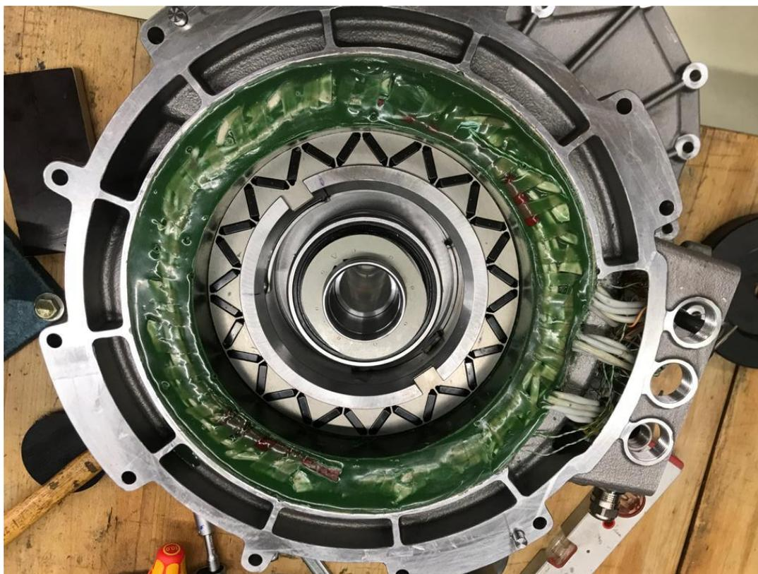
Abbildung 33 - RFM mit vergossenem Stator und eingebautem Rotor
