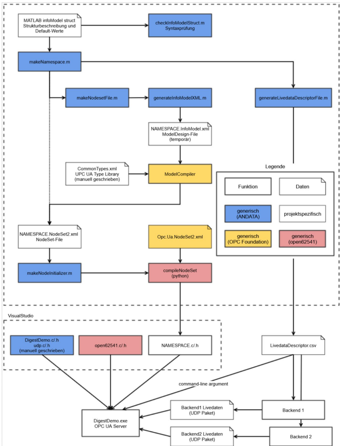
Abbildung 24 Toolchain zur Erstellung von Informationsmodellen und dessen Implementierung in einen OPC UA Server
