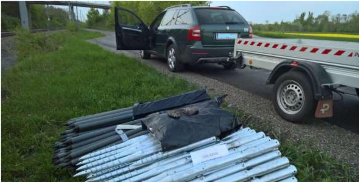
Abb. 77: Bodenschrauben und Montagegestangen
