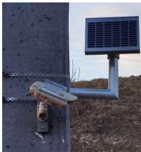
Abb. 120a: Durch Winddruck verstellter Trigger
