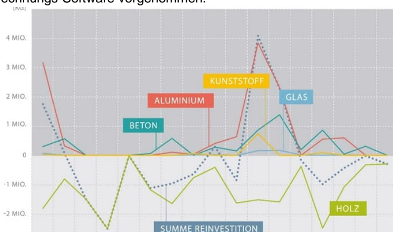
ABB 1. Simulation des CO 2 -Aufkommens auf Basis einer 15-Jahres Reinvest-Prognose des gesamten ASFINAG-Lärmschutzwand-Portfolios
