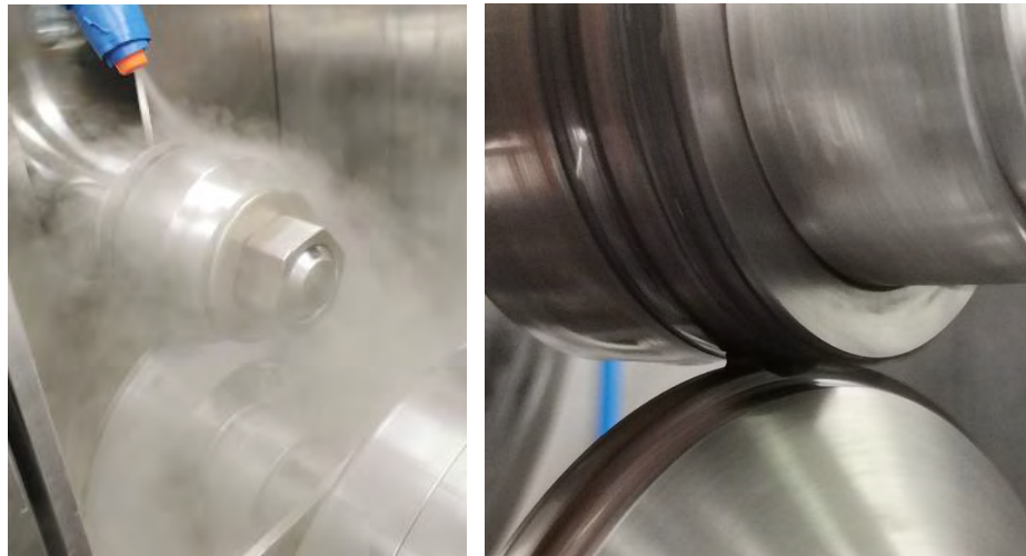
Abbildung 48: Hochlast-ZST – Wasseraufbringung (links), Wasserkeil vor dem Kontakt bei reduziertem Sprühnebel (rechts)
