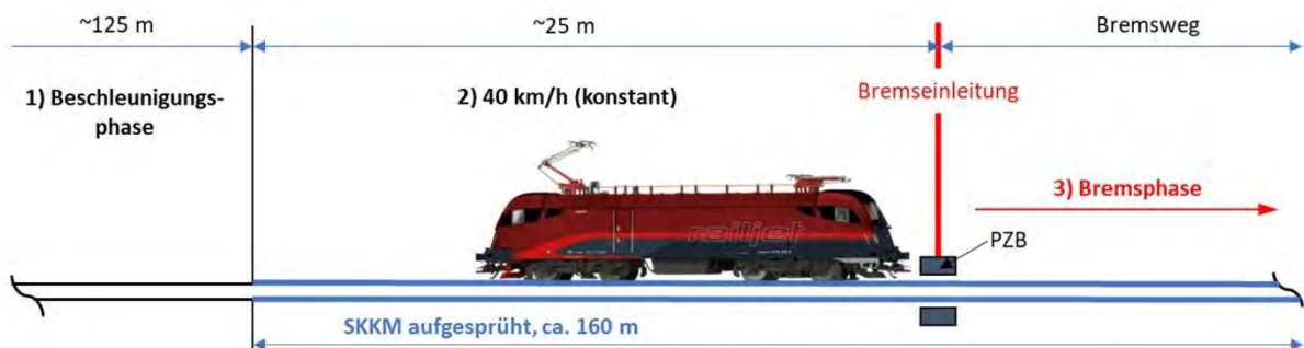
Abbildung 83. Drei Phasen einer Bremsmessfahrt bei Aufbringung von SKKM durch Sprühen 98
