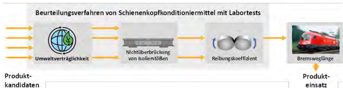
Abbildung 18: Mehrstufiges Beurteilungsverfahren von SKKM im Projekt „SafeRail“
