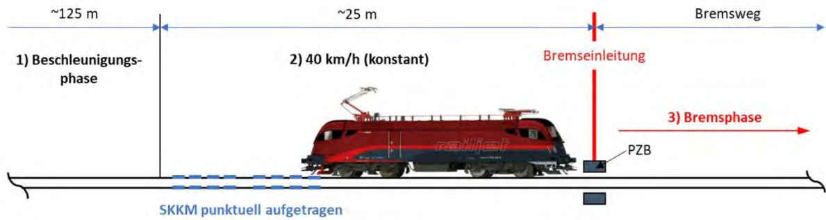
Abbildung 82: Drei Phasen einer Bremsmessfahrt bei punktueller Aufbringung von SKKM 98
