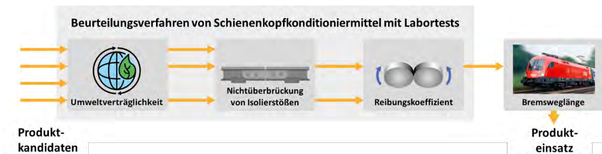
Abbildung 96: Mehrstufiges Beurteilungsverfahren von SKKM überwiegend als Labortests realisiert
