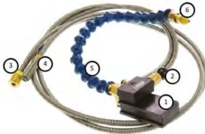
Abbildung 60: Sprühvorrichtung für den Rad-Schiene-Teststand und Feldversuche (1) magnetischer Ventilblock, (2) Ein/Aus-Schalter, (3) Druckluftversorgung, (4) Saugleitung, (5) Zuleitung, (6) verstellbare Düse
