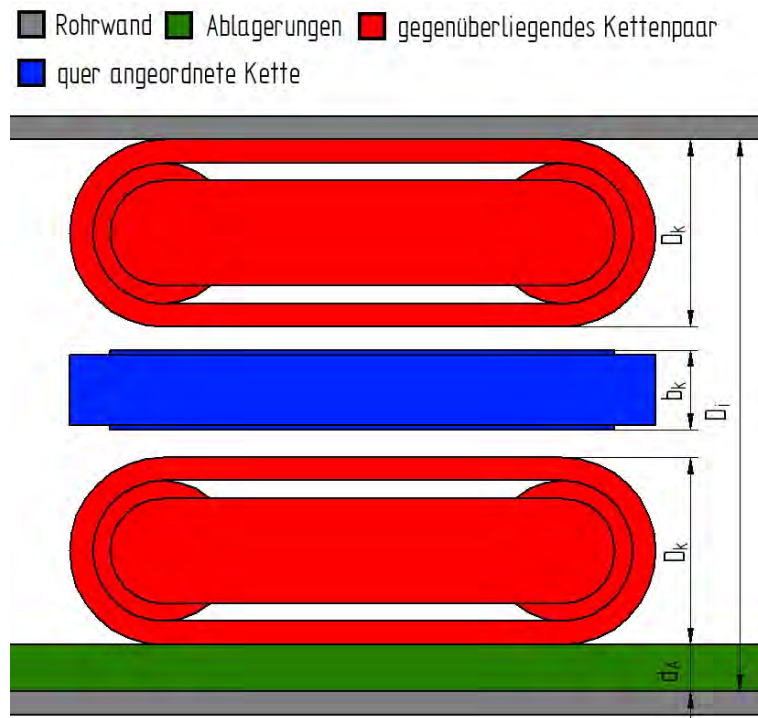
Abbildung 4.36: Berechnung des maximalen Kettenaußendurchmessers.
