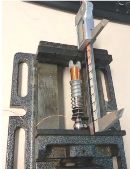
Abbildung 5.65: Aufbau zur Ermittlung der Sensorkennlinie.
