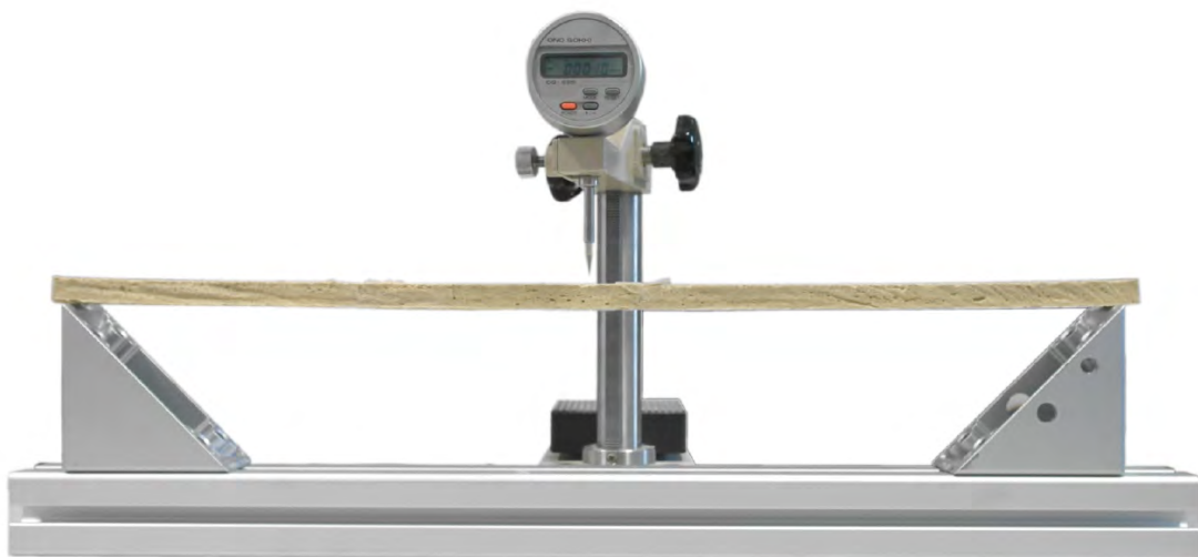
Abbildung 3.22: Als Auflager für die Messung der Durchbiegung wurden Aluminiumprofile verwendet.
