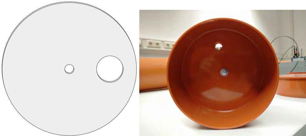
Abbildung 4.7: Skizze (links) und Foto (rechts) des verstellbaren Exzenter als Querschnittsveränderung.
