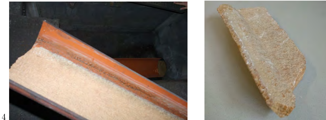
Abbildung 2.2: Typische Versinterungen, links: Rohr mit geringer Ablagerungsdicke, Foto Ernst Blecha, 5. November 2018, rechts: Dicke Versinterung, Foto Gabriel Ecker, 17. Oktober 2019
