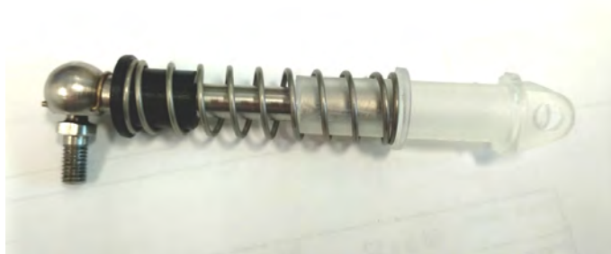
Abbildung 5.19: Aufbau ohne Sensorspule, Foto: Gabriel Ecker, 18. Juli 2019.
