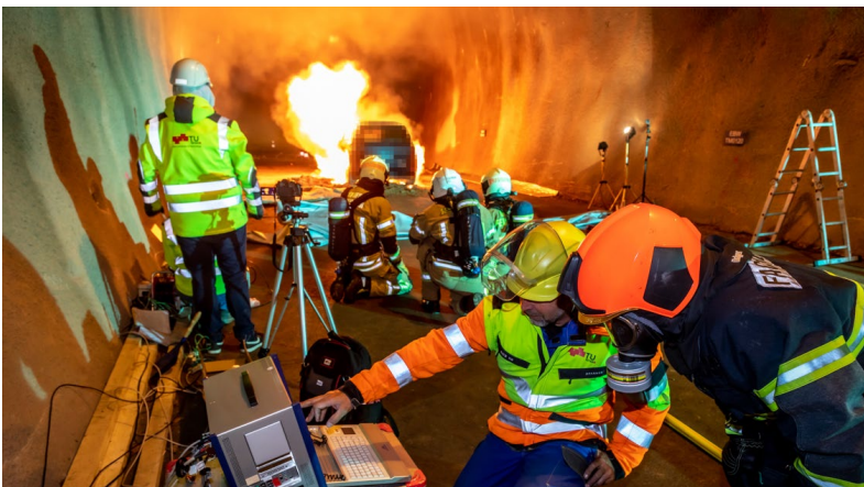
ABB 1. Brandversuch mit einem E-Fahrzeug, © TU Graz, Lunghammer
