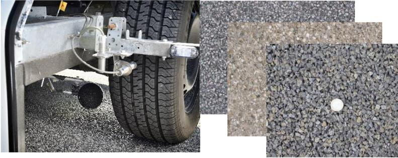
ABB 2. Mikrofon und Messreifen mit verschiedenen Fahrbahndeckentypen
