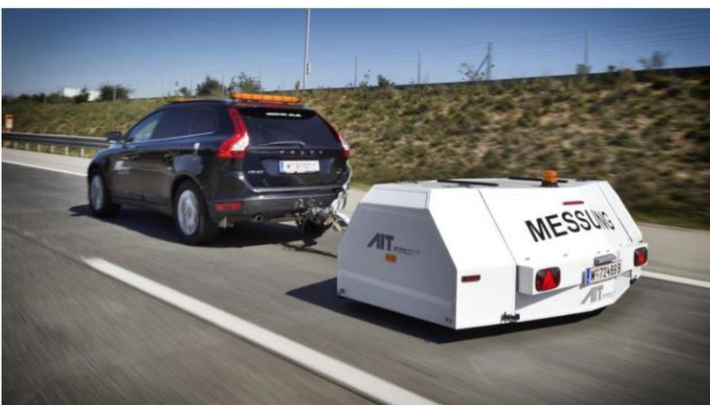
ABB 1. Lärmmessanhänger nach ISO 11819-2 mit Zugfahrzeug
