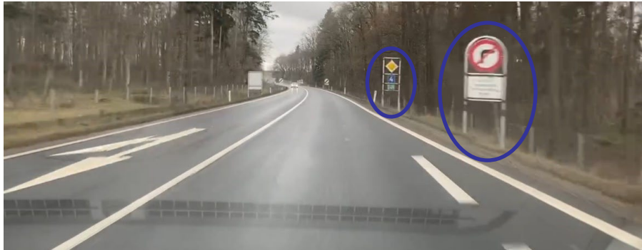
Abb. 4-26: Blick auf das Ende des Beschleunigungsstreifens in Maissau 2 mit den zwei Verkehrszeichen zur potenziellen Befestigung von Messgeräten: Das Erste VZ (Rechtsabbiegen verboten) wurde aufgrund der besseren Sicht ausgewählt
