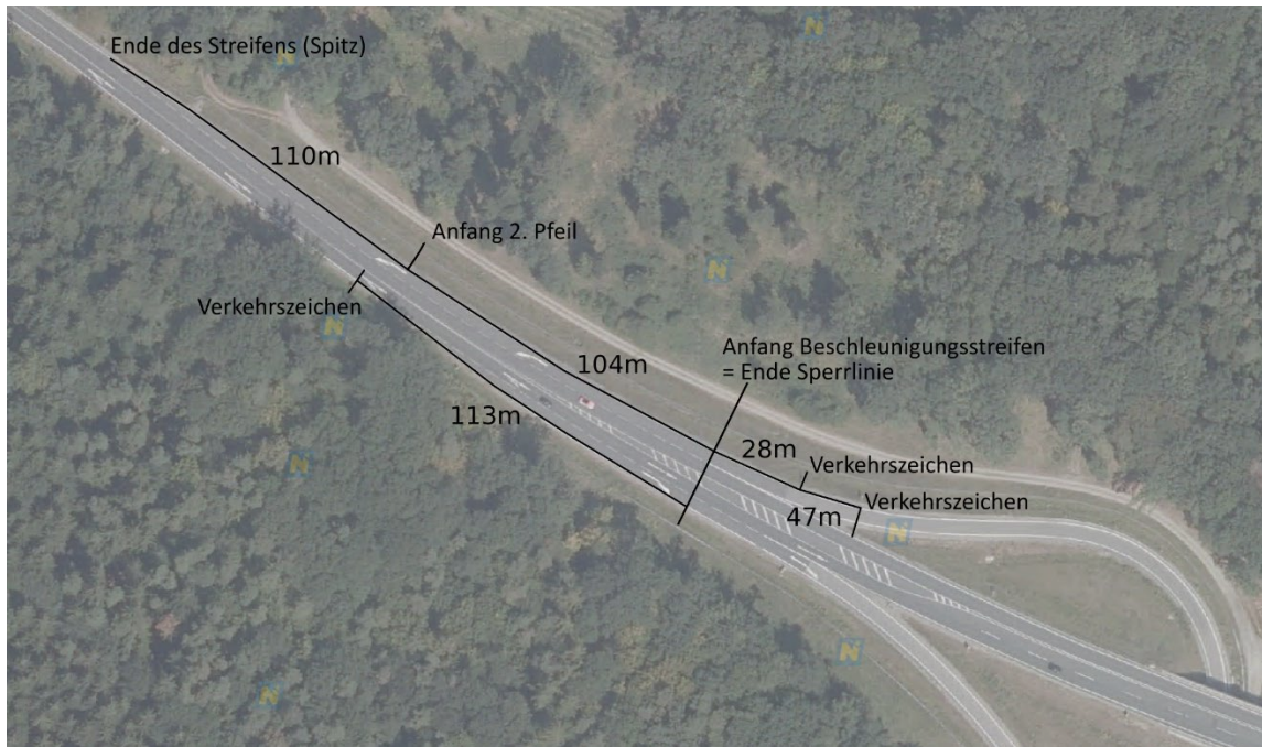
Abb. 4-22: Orthofoto inklusive Kennzeichnung der Längen des Beschleunigungsstreifens und Standorten der Kameras (Maissau 2)
