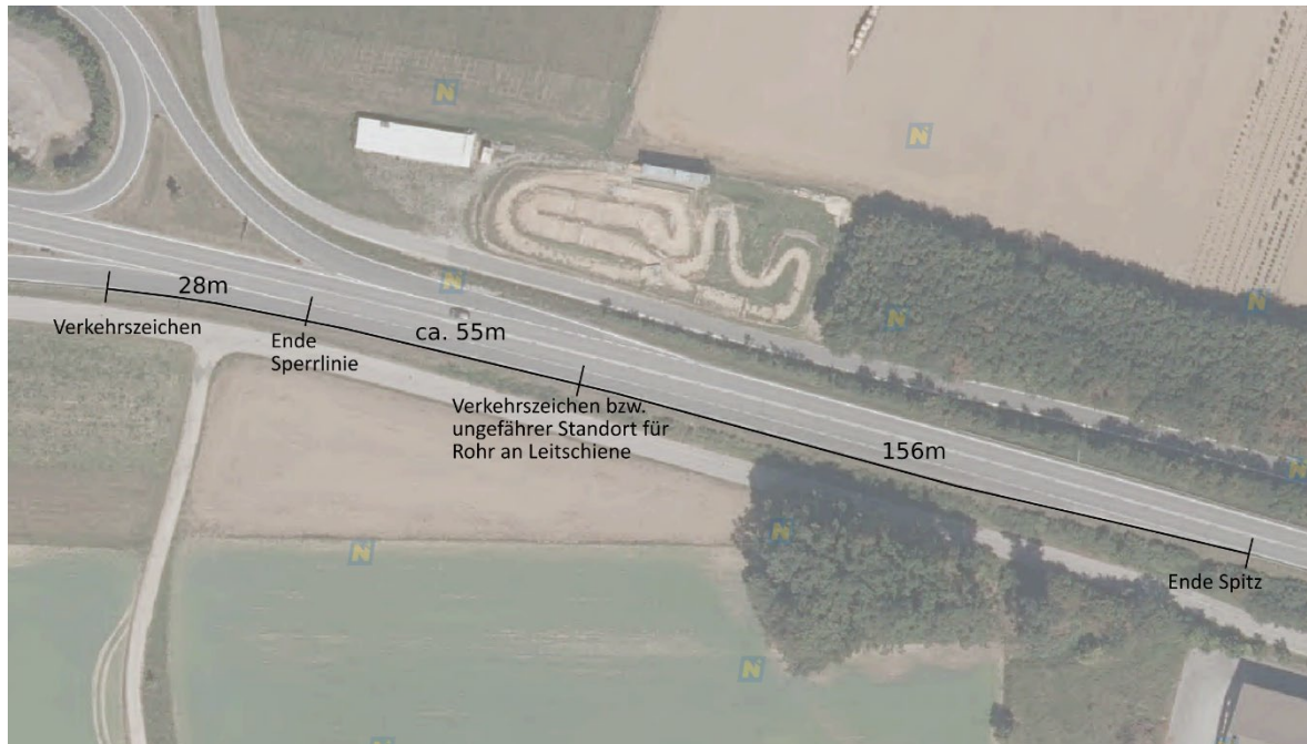
Abb. 4-11: Orthofoto inklusive Kennzeichnung der Längen des Beschleunigungstreifens und potenziellen Standorten der Kameras (Gföhl 2) Bildquelle: NÖ Atlas ( https://atlas.noel.gv.at ), eigene Darstellung
