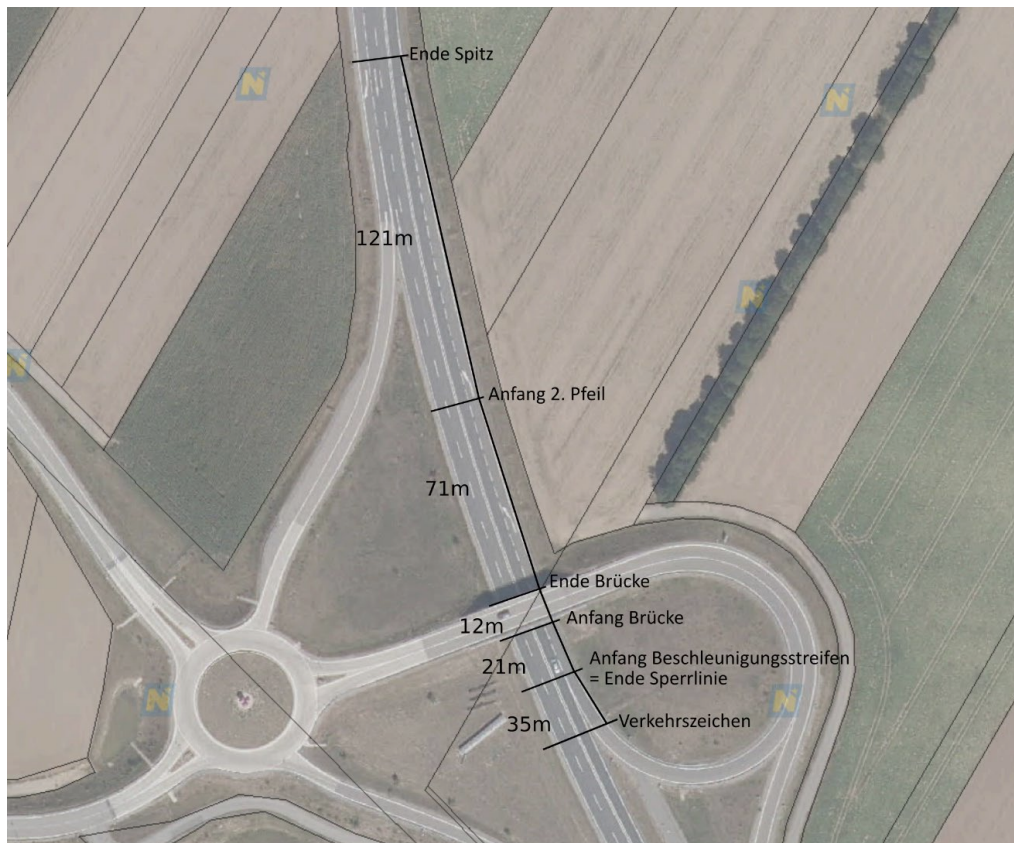
Abb. 4-17: Orthofoto inklusive Kennzeichnung der Längen des Beschleunigungsstreifens und Standorten der Kameras (Maissau 1)
