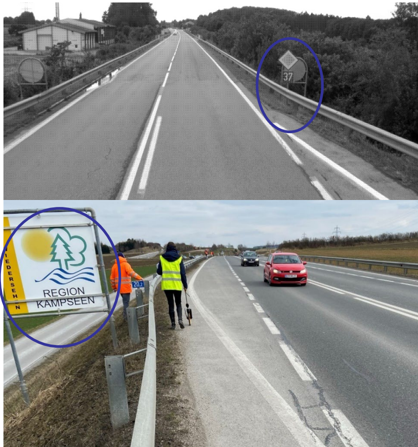
Abb. 4-10: Ende des Beschleunigungsstreifens in Gföhl 1: Ansicht in Fahrtrichtung mit geeignetem Verkehrszeichen (oben); Ansicht entgegen der Fahrtrichtung mit geeignetem Schild (unten)
