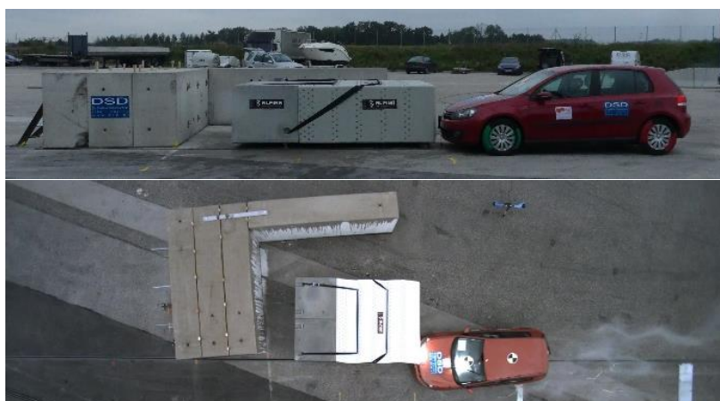
ABB 1. Gemäß EN 1317 abweichende nAnprallkonfiguration
