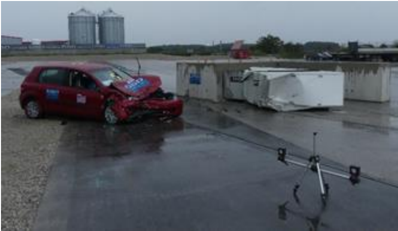
ABB 2. Endlage des Fahrzeugs nach dem Anprall
