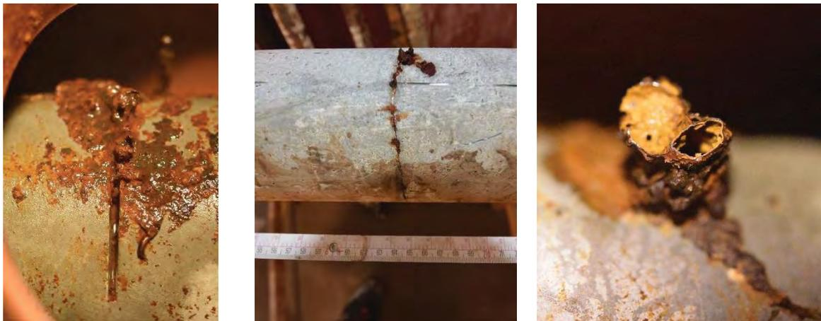
**Abb. 72:** Beispiele für Korrosionsprodukte
