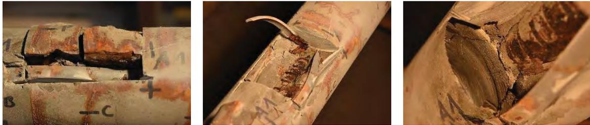
**Abb. 59:** Links: Angeschnittene Abstandhalter und leicht lösbarer Mörtel, Mitte: Elektrolyteinlagerung unter dem Abstandhalter, Rechts: Fortpflanzung des Risses A1 entlang des Abstandhalters
