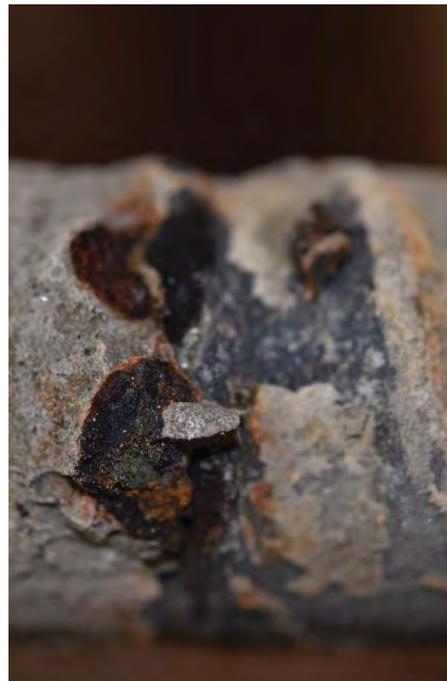
**Abb. 73** Lochfraßkorrosion bei DAT\_VK\_04
