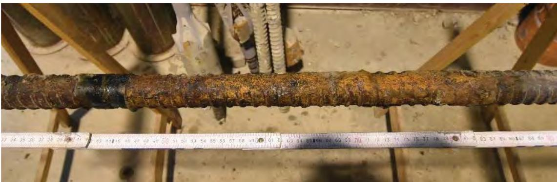
**Abb. 70: Korrosion über die gesamte Länge der Korrosionswanne**
