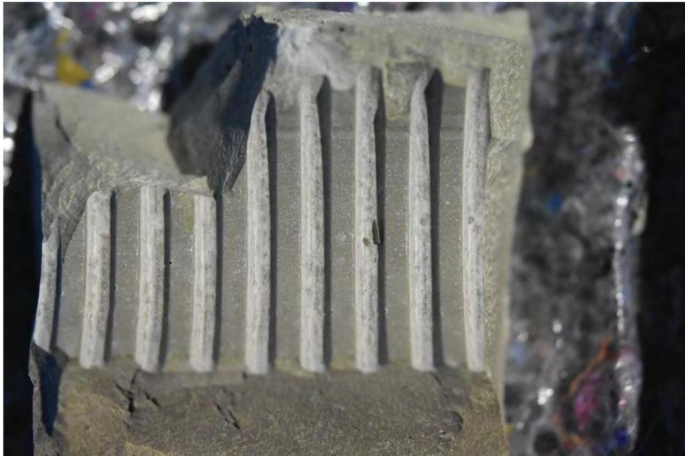
**Abb. 89:** Bruchstück des äußeren Verpresskörpers mit Verbundrippen
