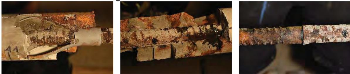
**Abb. 60:** Links: Korrosion und Rissbild im Bereich eines Abstandhalters, Mitte: Korrosion durch Einlagerung des Elektrolytes in den Versuchskörper, Rechts: Korrosionserscheinungen in der Auflagefläche des Abstandhalters
