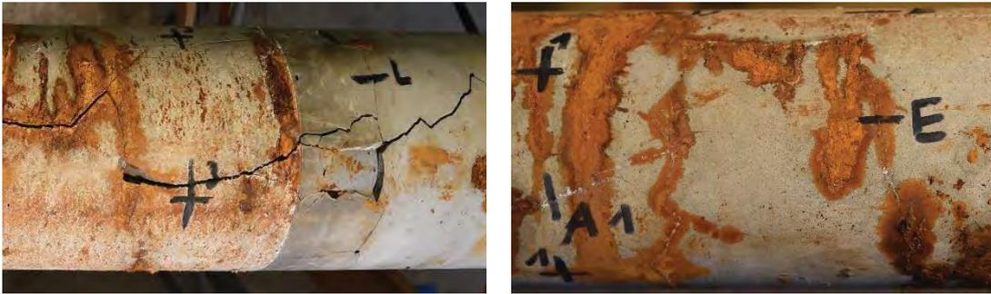
**Abb. 55:** Links: Riss entstanden während dem Entspannen; Rechts: Risse welche während dem Spannen entstanden sind und daher auch Korrosionsablagerungen aufwiesen
