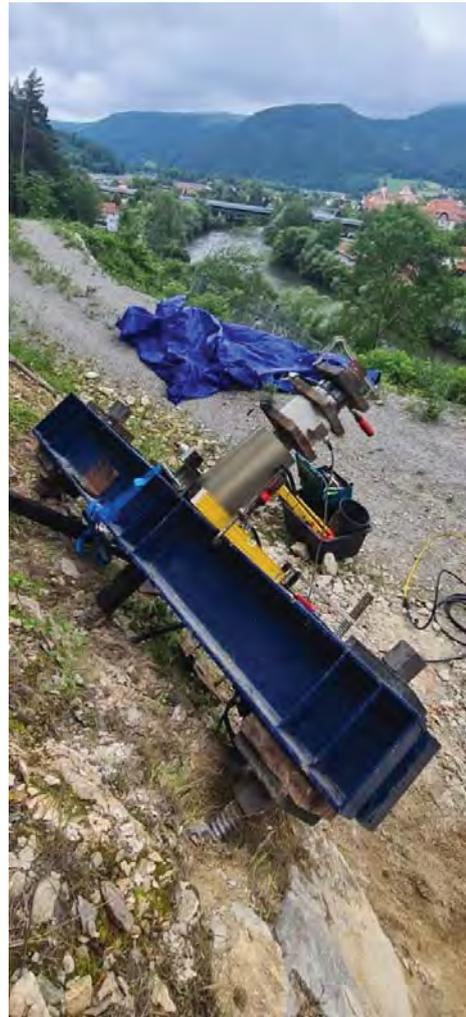
**Abb. 139: Beispiele zum Aufbau des Prüfaufbaues mittels Reaktionspfählen**
