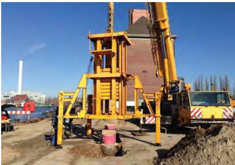
**Abb. 101:** Beispiel eines Versuchsaufbaues für DLT mit einem Fallgewicht (Allnemics, 2021)
