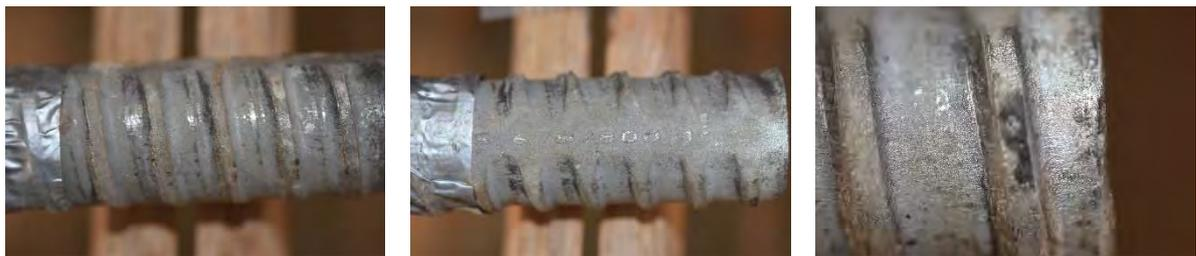
**Abb. 67:** Beschädigung der Verzinkung im Bereich der Muffe
