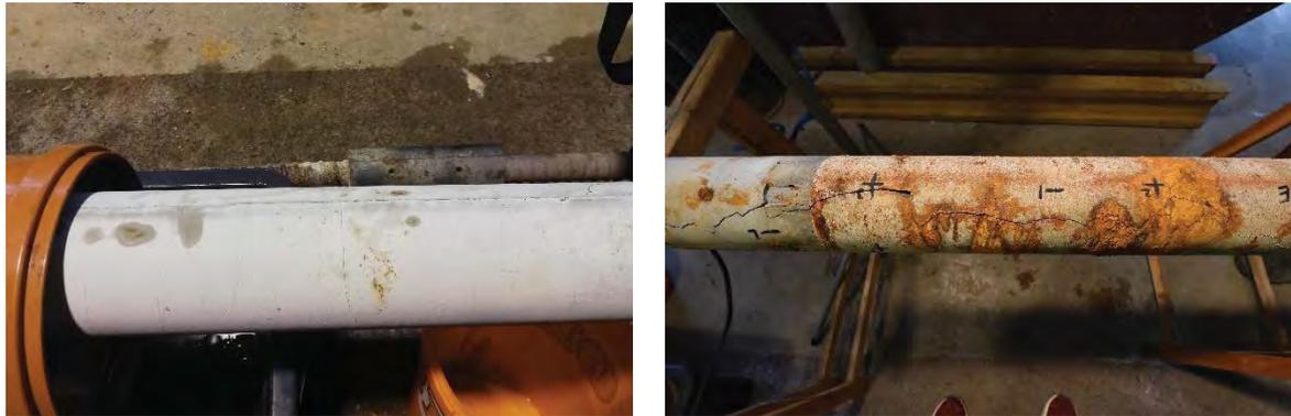
**Abb. 71:** Links: Querrisse beim Spannen; Rechts: Längsriss nach dem Ausbau
