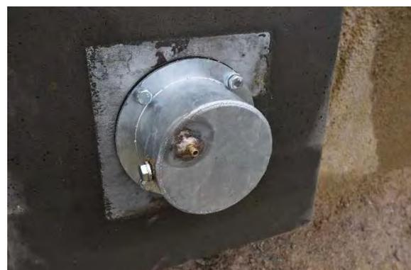
**Abb. 28:** Links: gespannter Anker; Rechts: Installiere Messhaube
