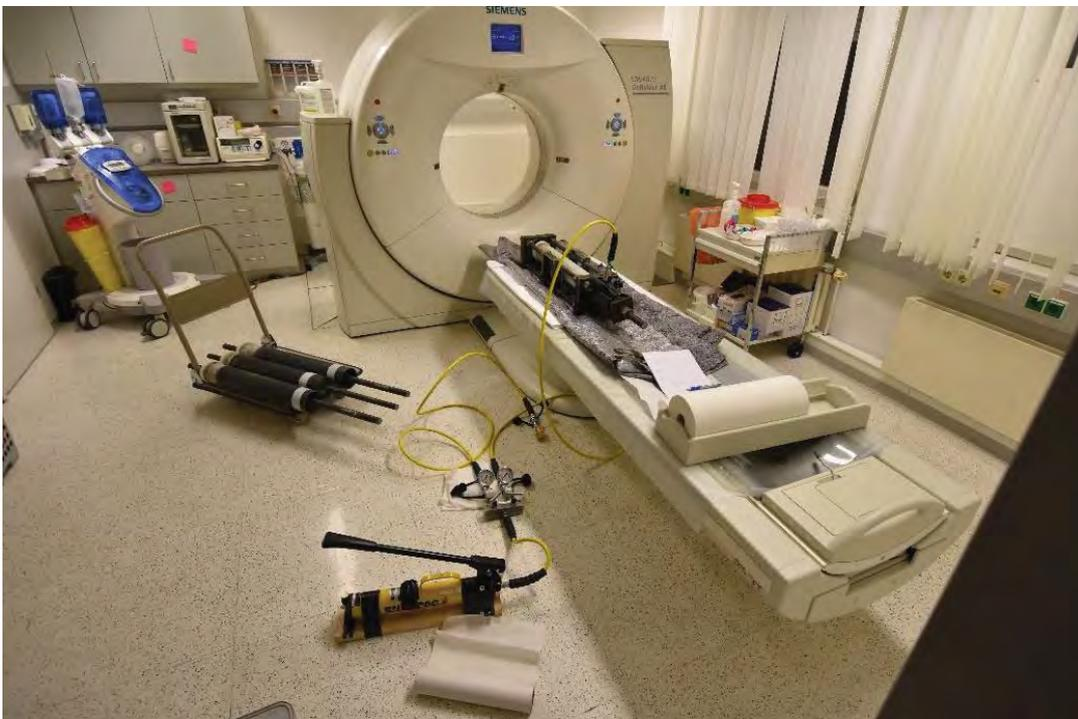
**Abb. 82:** Prüfaufbau im Computertomographen
