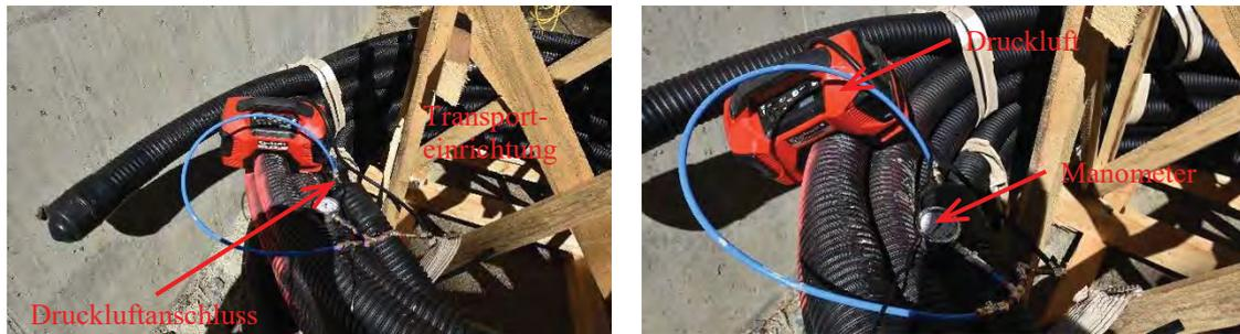
**Abb. 37: Vorabprüfung Anker 1 – im Anlieferzustand**
