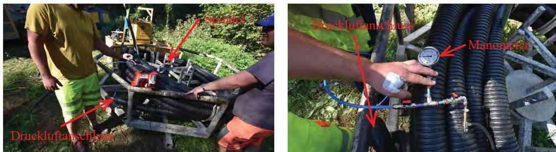
**Abb. 38: Vorabprüfung Anker 2 – aufgebaut auf Spindel**
