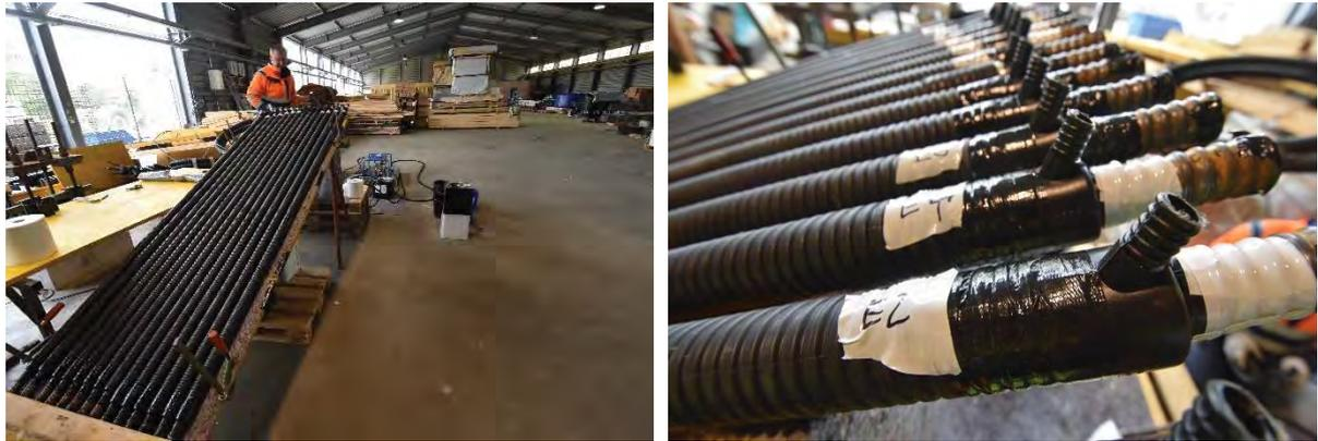
**Abb. 24:** Validierung DCP-SBZ; Herstellung Probekörper für Feldversuche (links); Detail Anschluss Ripprohr an metallisches Zugglied (rechts)
