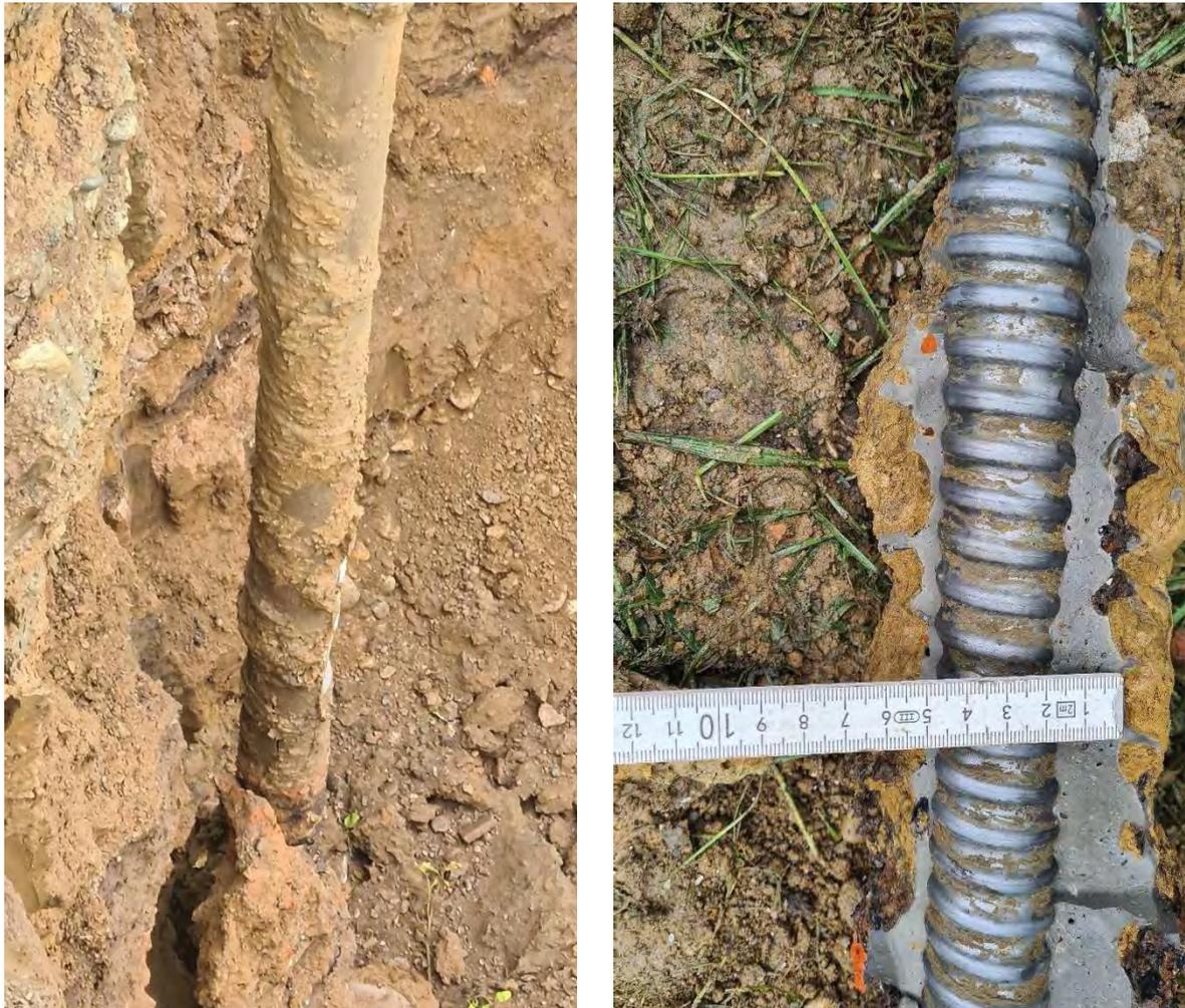
**Abb. 94:** Verpresskörper im Zuge des Freilegens; Verpresskörper verrohrte Bohrung (links); Verpresskörper selbstbohrendes Element (rechts)
