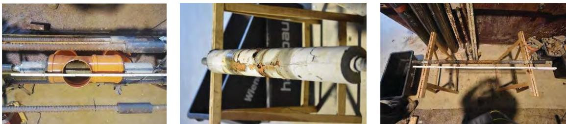
**Abb. 68:** Links: Zweiter Korrosionsabschnitt; Mitte: DAT\_VK\_06 nach dem Ausbau; Rechts: Freigelegter Bewehrungsstab
