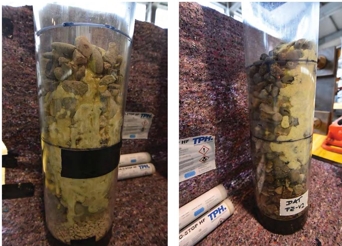
**Abb. 44: Ergebnisse der Vorversuche; Links: trockener Kieskörper – Eindringtiefe ~27 cm; Rechts: feuchter Kieskörper – Eindringtiefe ~20 cm**
