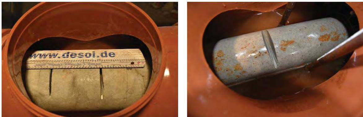
**Abb. 54:** Künstliche Schädigungen an der Zementsteinüberdeckung; Links: DAT\_VK\_02 – zwei parallele Schnitte; Rechts: DAT\_VK\_03 – keilartiger Einschnitt
