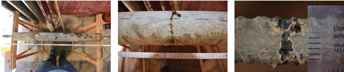
**Abb. 66:** Links: kompletter Versuchskörper mit Meterstab; Mitte: Querriss B mit Korrosionsablagerung; Rechts: Korrosion am Bewehrungsstab
