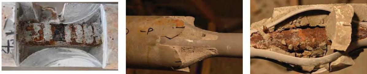
**Abb. 64:** Links: Korrosion im Bereich der Schwächung, Mitte: Rissbild beim oberen Abstandhalter, Rechts: Unterer Abstandhalter
