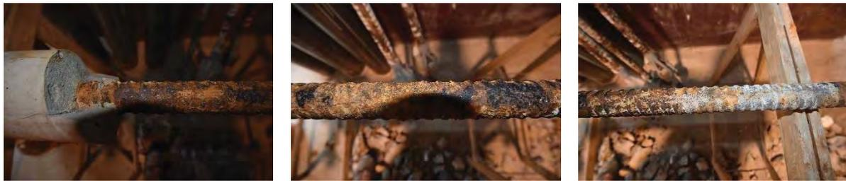
**Abb. 69:** Links: Unteres Ende mit verbleibenden Betonkörper; Mitte: Mitte Stab mit Korrosionsschäden; Rechts: Oberes Stabende
