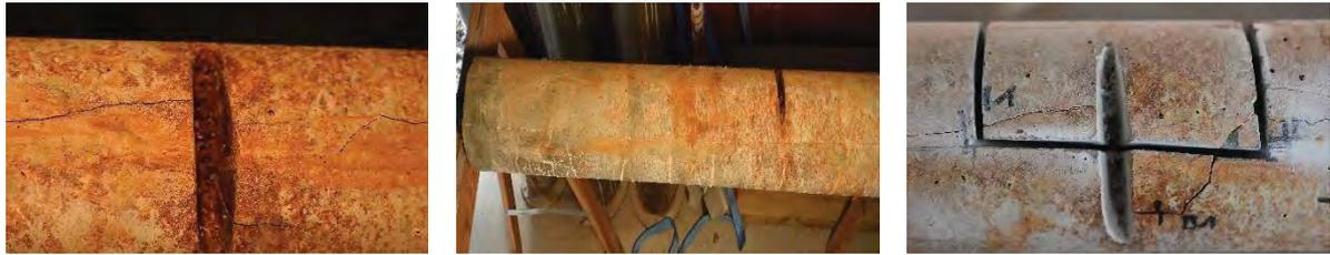
**Abb. 63:** Links: Ablagerungen im Bereich des Einschnittes, Mitte: DAT\_VK\_03 nach der Korrosion, Rechts: Einschnitt während des Freilegens
