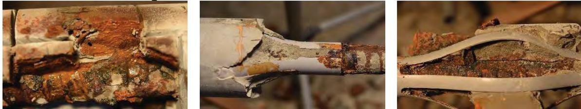
**Abb. 62:** Links: Einfluss der Querschnittsschwächung auf die Korrosion, Mitte: Oberer Abstandhalter, Rechts: Unterer Abstandhalter
