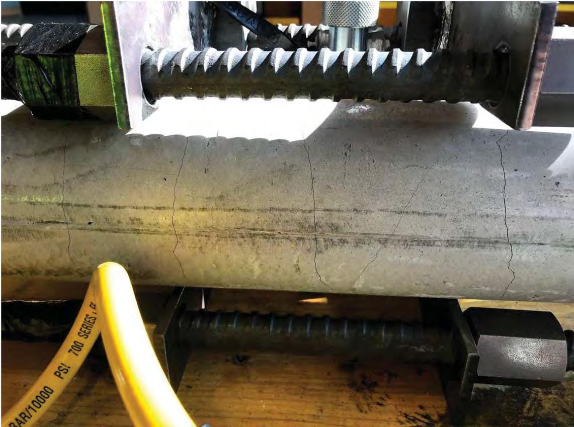
**Abb. 80: Voruntersuchung – Rissentwicklung unter  $50\% \cdot F_{max}$**
