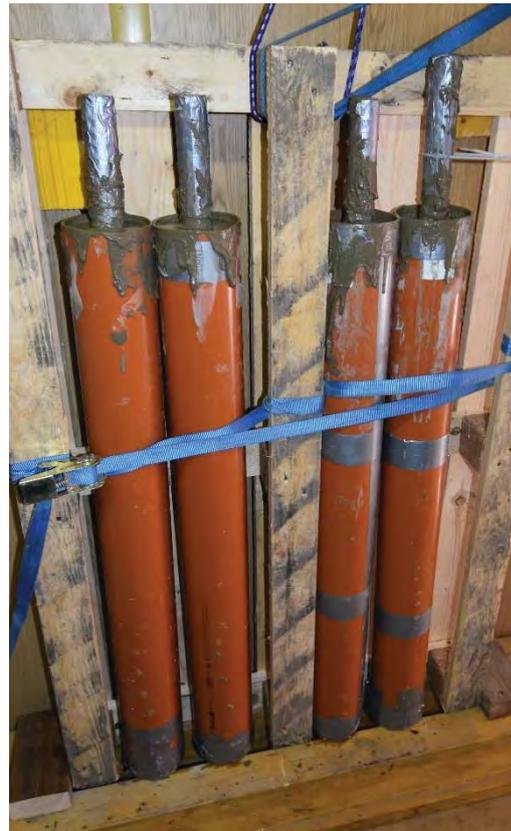
**Abb. 53:** Herstellung der Versuchskörper; Links: Skizze; Rechts: Betonage der Versuchskörper
