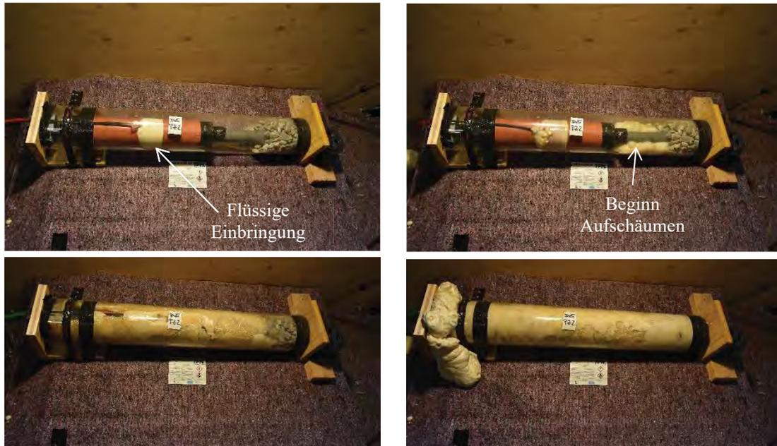
**Abb. 47:** Bildreihe (quer) der Versuchsdurchführung; links oben: Beginn des Einfüllprozesses; rechts oben: Verfestigung im Fußbereich; links unten: Verdichten des Verfüllkörpers; rechts unten: nach der Versuchsdurchführung
