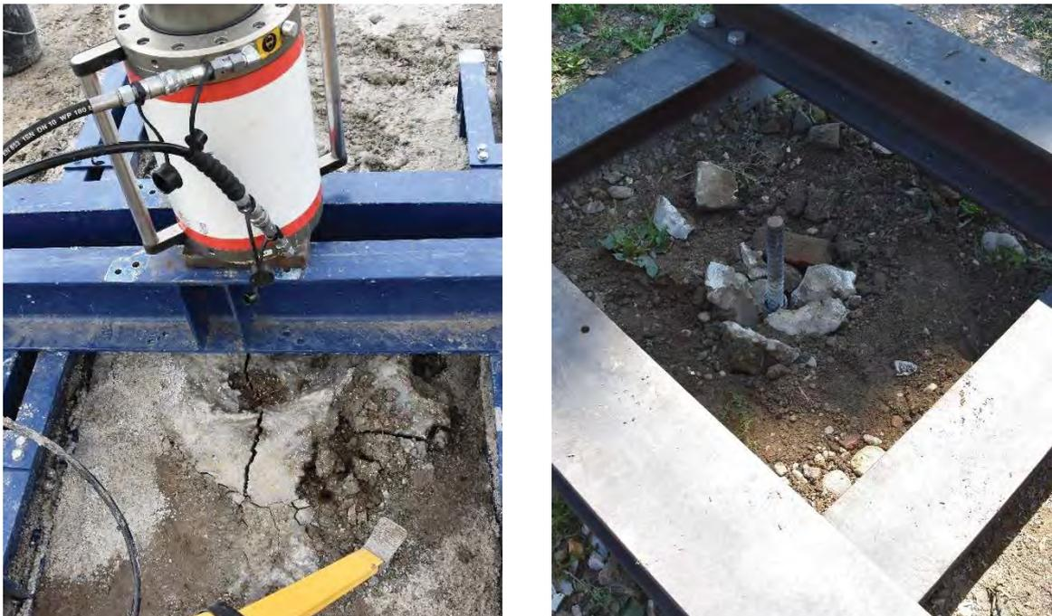
**Abb. 95:** Zustand des Kopfbereiches des Mikropfahles bei Prüfungen; statische Prüfung (links); dynamische Prüfung (rechts)
