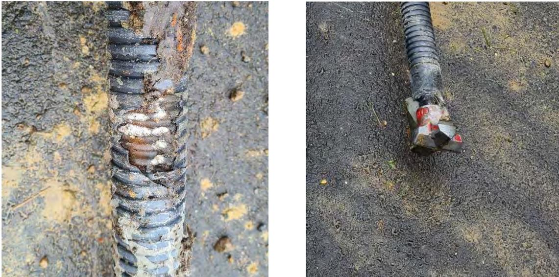
**Abb. 96:** Freigelegte DCP-SBZ; Ripprohr am Korrosionsschutz (links); Bohrkronen (rechts)
