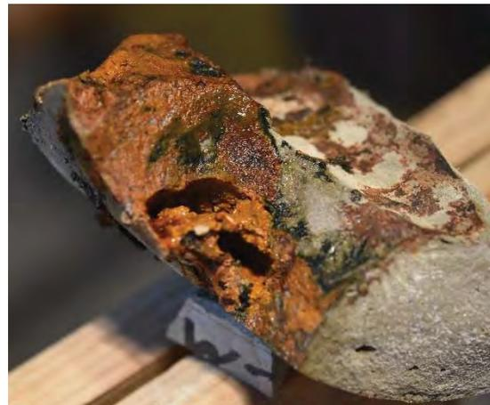
**Abb. 74:** Beispiele für Korrosionsprodukte in Luftporen bzw. Verdichtungsnestern
