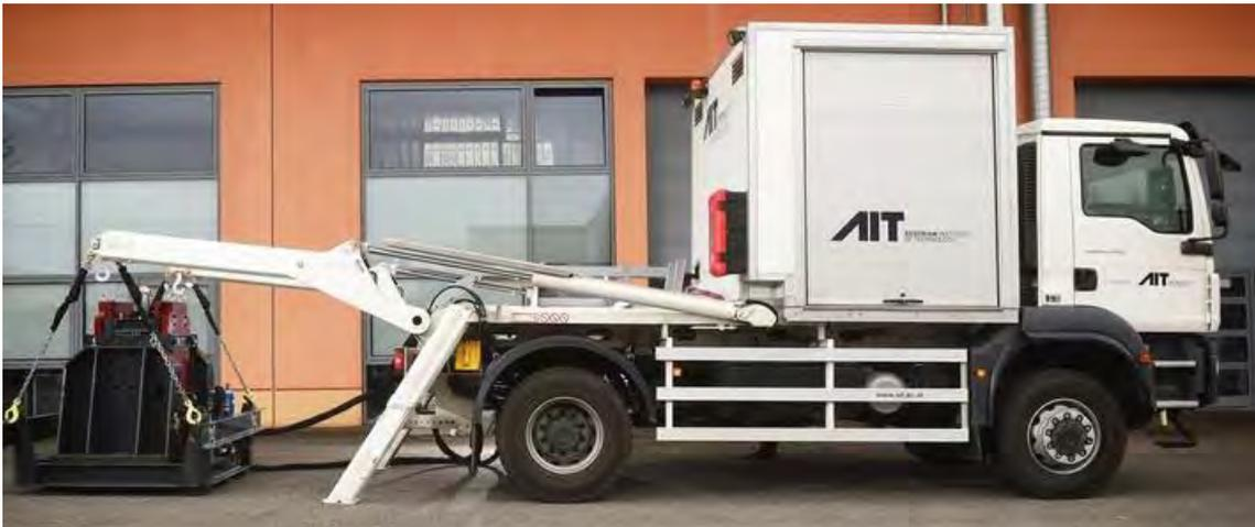
**Abb. 100: Gesamtaufbau des Mobile Seismic Simulator (Austrian Institute of Technologie, 2021)**
