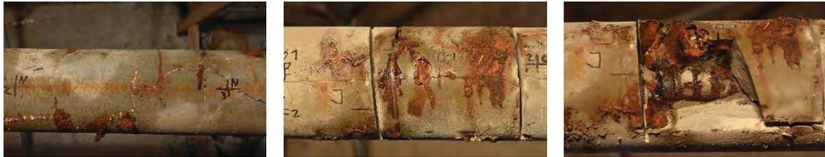
**Abb. 61:** Links: Rissbild des Versuchskörpers, Mitte: Längsriß B1, Rechts: Korrosion durch Längsriß B1
