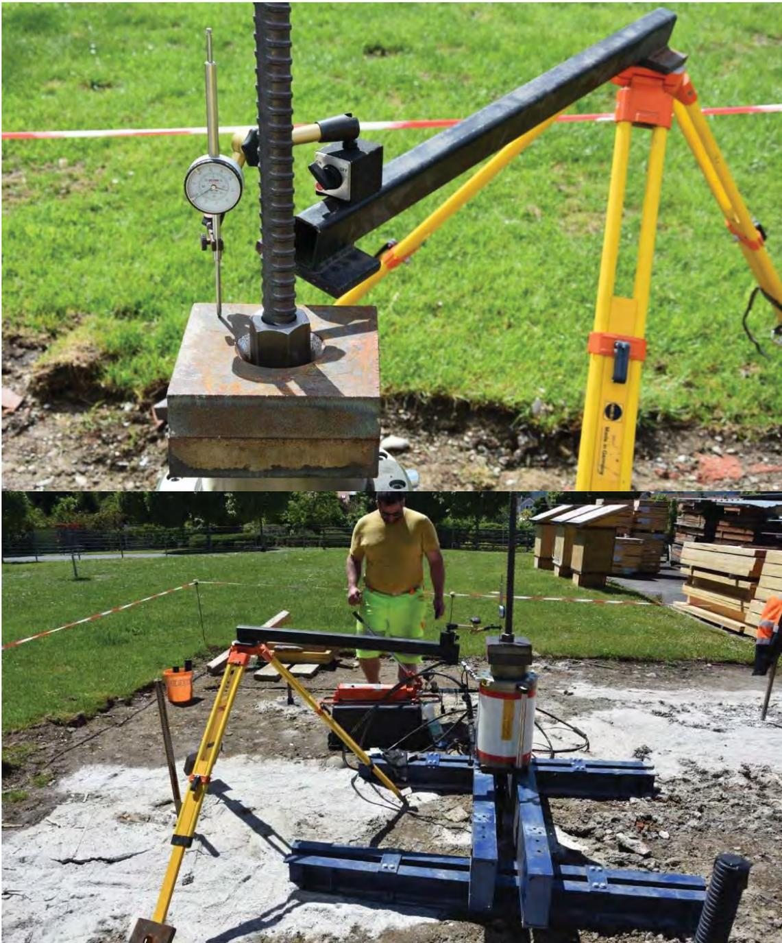
Abb. 120: Statische Zugversuche, (DAT, 2021); Aufbau Messuhr (oben); Prüfaufbau (unten)
