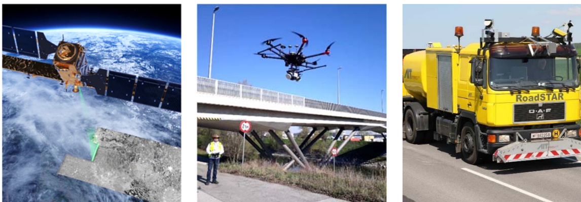
Abbildung 1: Drei angewandte Messmethoden: Satellitenradar (links), UAV-Laserscanning (Mitte) und mobiles Laserscanning (rechts).
