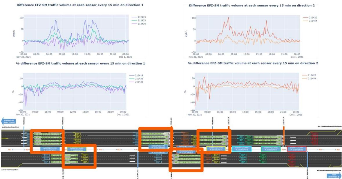
Abbildung 26: Verkehrsstärke Ganglinien Vergleich Smartmicro Radardaten vs. Einzelfahrzeug-Datensatz – 30.11.2021
