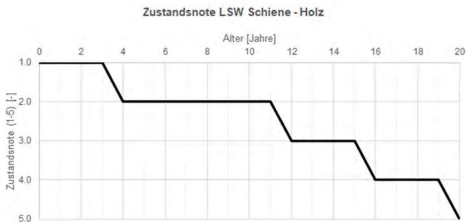
**Abbildung 11: Zustandsprognosemodell LSW Schiene
