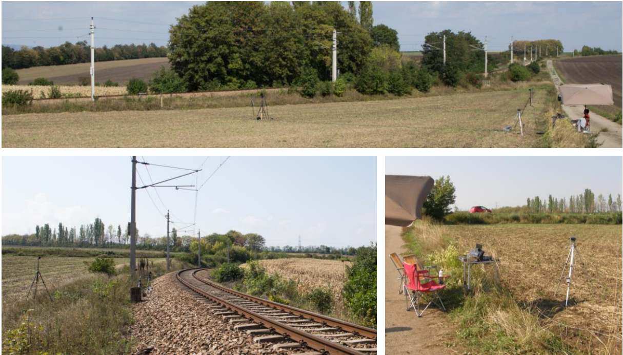
Abb. 2-6: Messbogen Platt – Dammlage der eingleisigen Strecke und hin zu entfernteren Messpunkten leichter Geländeanstieg ohne Bewuchs im Bereich der akustischen Messungen (oben), Emissionsmessungen und Doppellaserlichtschranke (unten links) und Messplatz hinter entferntestem Messpunkt mit Videokamera (unten rechts)
