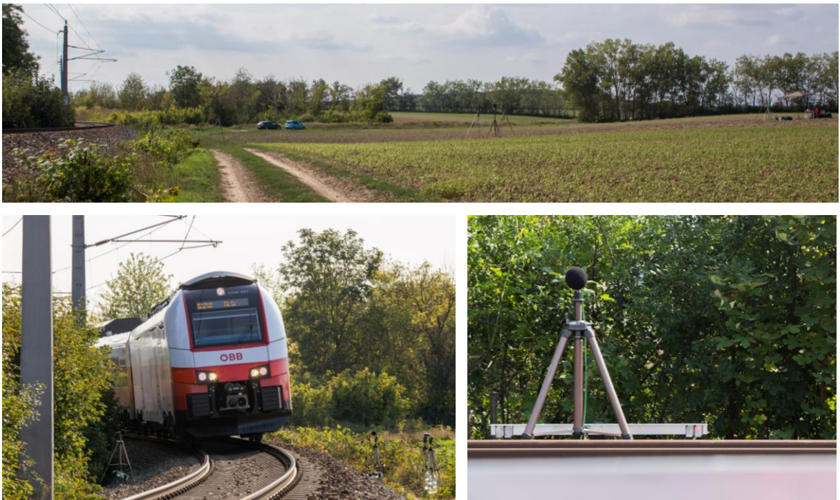
Abb. 2-7: Messbogen Zellerndorf – Dammlage der eingleisigen Strecke und hin zu entfernteren Messpunkten mäßiger Geländeanstieg ohne Bewuchs im Bereich der akustischen Messungen (oben), gleisnahe Emissionsmessungen und Doppellaserlichtschranke (unten links) und Reflektoren der Lichtschranken mit Laserpunkt auf rechtem Reflektor (unten rechts)
