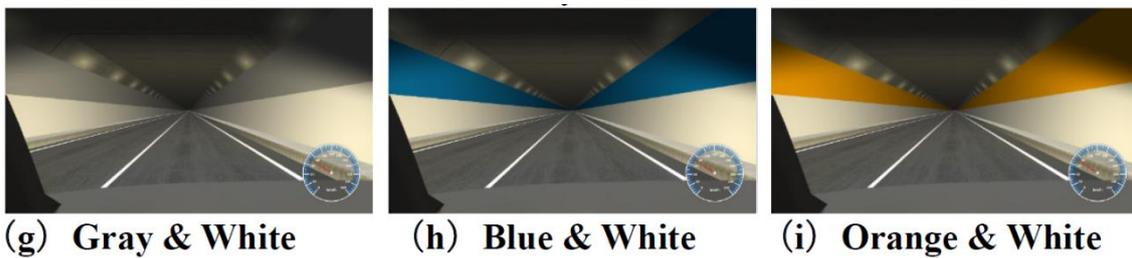
**Abbildung 73: Untersuchte Tunnelwandfarbkombinationen (Hu et al., 2019)**
