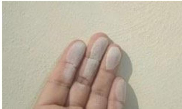
**Abbildung 31: Alter Lack mit Kreidung durch Abrieb; Farbpigmente lösen sich**
