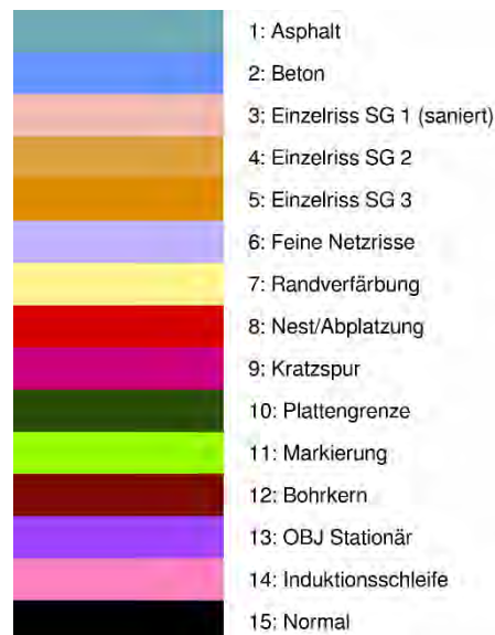
Abbildung 17: Farbpalette für die Visualisierung von Schäden und Objekten auf Betonoberflächen.
