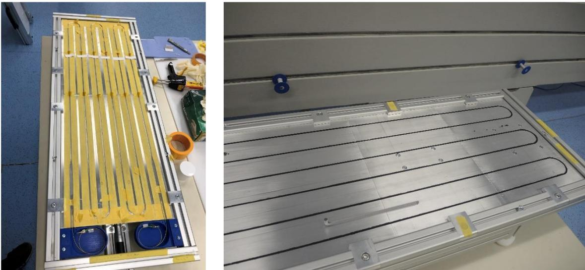
**Abbildung 18: Laborsetup S2: Verklebung der blanken Glasfaser in einer vordefinierten Faserstrecke zur Untersuchung der Rissatmung**
