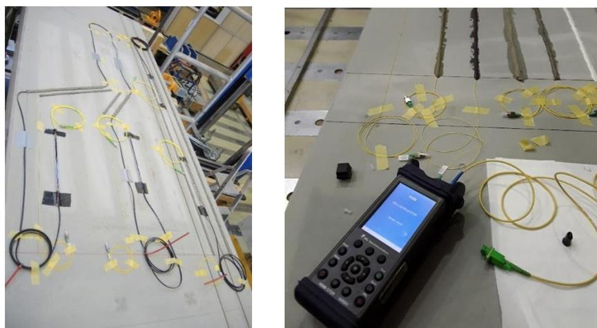
**Abbildung 37: Anspleißen von Steckern zur Verbindung mit dem Messinstrument (links) und Kontrolle auf Beschädigungen mittels eines OTDR (rechts)**
