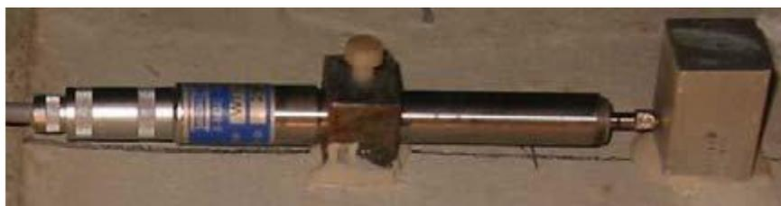
**Abbildung 3: Darstellung eines Wegaufnehmers (aus [6])**
