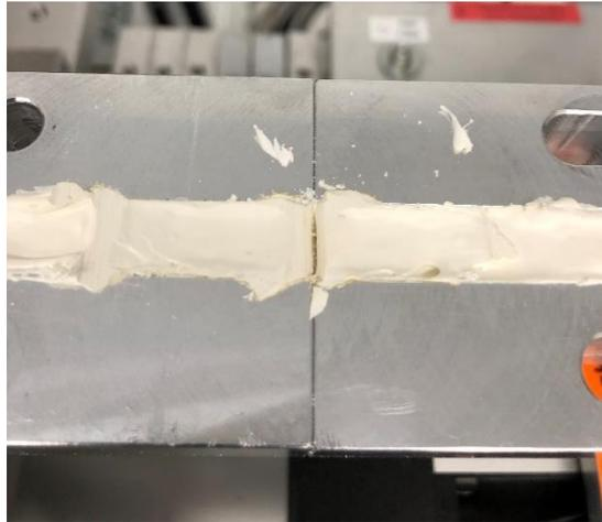
**Abbildung 19: Simulation des Erstrisses (Laborsetup S1)**
