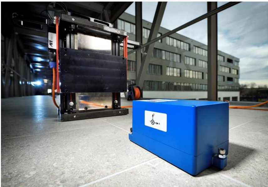
Abbildung 86: Long-Stroke-Shaker zur dynamischen Bauwerksanregung und Schwingungssensor
