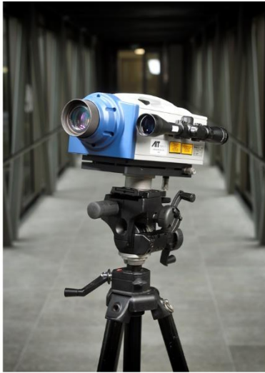
Abbildung 85: Laservibrometer zur kontaktlosen Bestimmung von Bauwerksschwingungen
