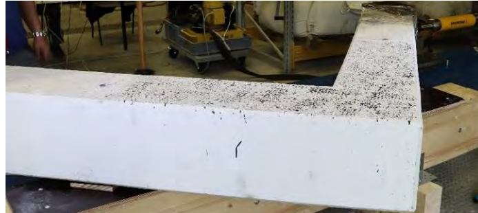
Abbildung 83: Messfeld mit Sprühmuster zur Erfassung der Dehnungen.
