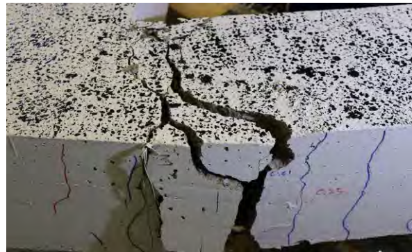
Abbildung 200: P05-02 Biegezugbereich beim Versagen mit Betonausbruch.
