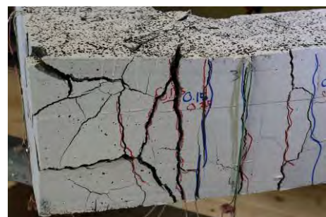
Abbildung 212: Vergleich der Spaltrisse im Nachbruch der Simulation N06 und beim zugehörigen Laborversuch P06.
