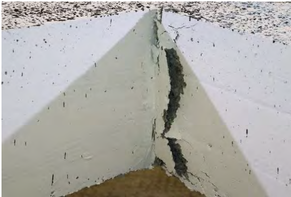
Abbildung 156: P01-02 Beginnendes Druckzonenversagen.
