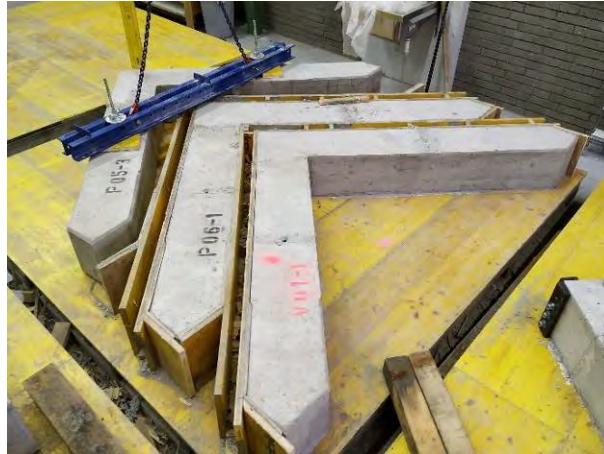
Abbildung 132: Anheben der Versuchskörper mittels Krans und Befestigungstraverse.
