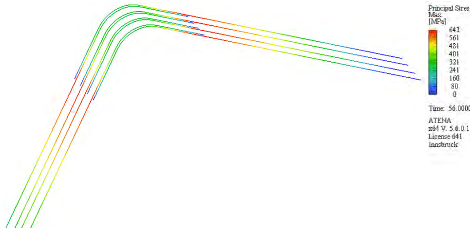
Abbildung 202: Spannungverteilung in der Bewehrung für Simulation N05 bei Höchstlast.
