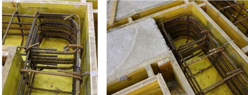
Abbildung 123: Übergreifungsstoß (links) und Ansicht nach der Betonage des ersten Schenkels (rechts) des Versuchskörpers P06-01.
