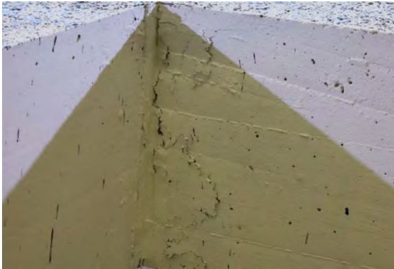
Abbildung 154: P01-01 Beginnendes Druckzonenversagen.
