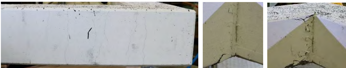
Abbildung 94: Bildung der Biegerisse im Verlauf der Belastung (links), beginnendes Versagen der Druckzone (Mitte) und fortgeschrittenes Druckzonenversagen (rechts).
