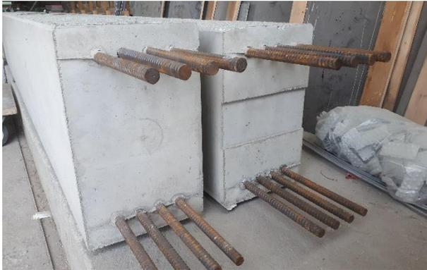
**Abbildung 46: VB 2 ohne Ausnehmung und VB 3 mit Ausnehmung am Balkenende**
