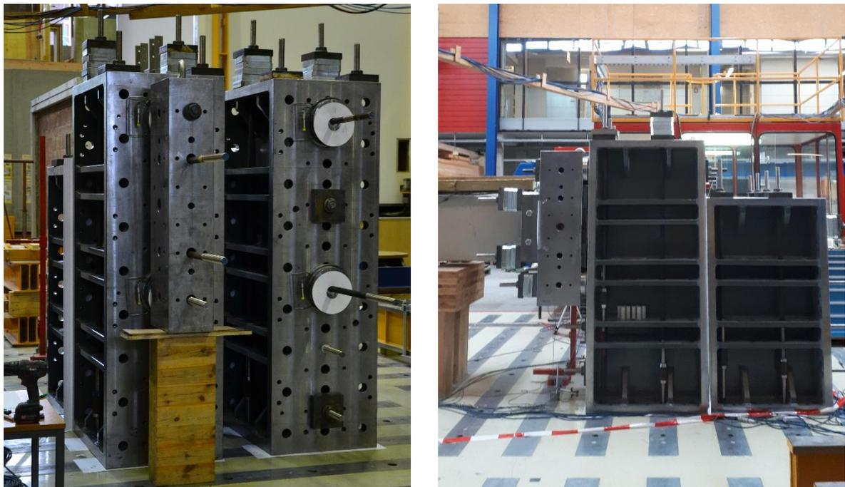
**Abbildung 36: Widerlager ‚rechts‘ während der Montage und im Endzustand**
