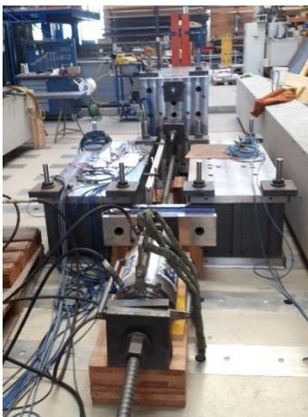
**Abbildung 40: Widerlager ‚links‘ – horizontale Spannstange**
