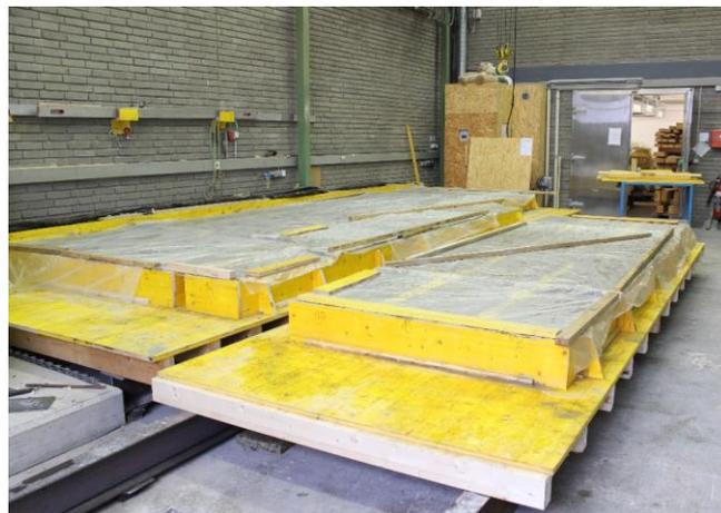
**Abbildung 93: Betonierte und nachbehandelte Versuchskörper**
