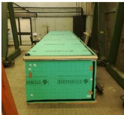
**Abbildung 109: Thermische Einhausung des Versuchsstands**
