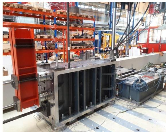
**Abbildung 41: Widerlager ‚links‘ – unteres Reaktionswandelement inklusive Überbrückungsträger**
