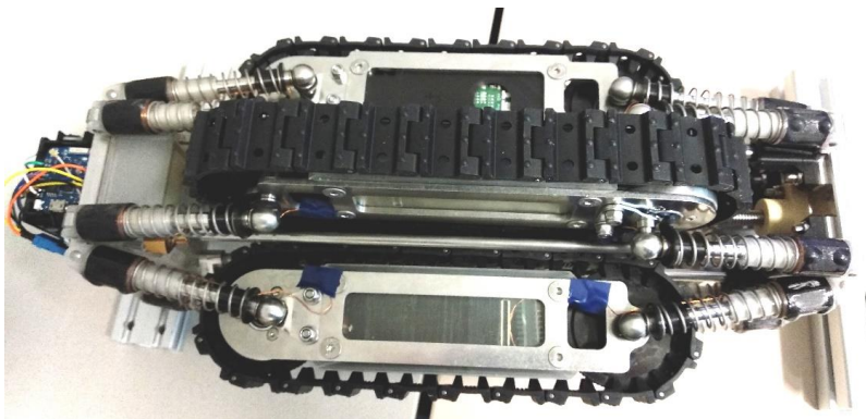
Abb. 2. Tunnelroboter vor dessen Adaptierung zu einer wasserfesten Ausführung
