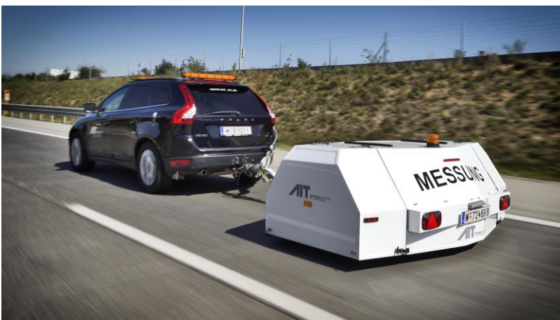
ABB 1. Messung von Textur und Rollgeräusch mittels AIT CPX-Anhänger
