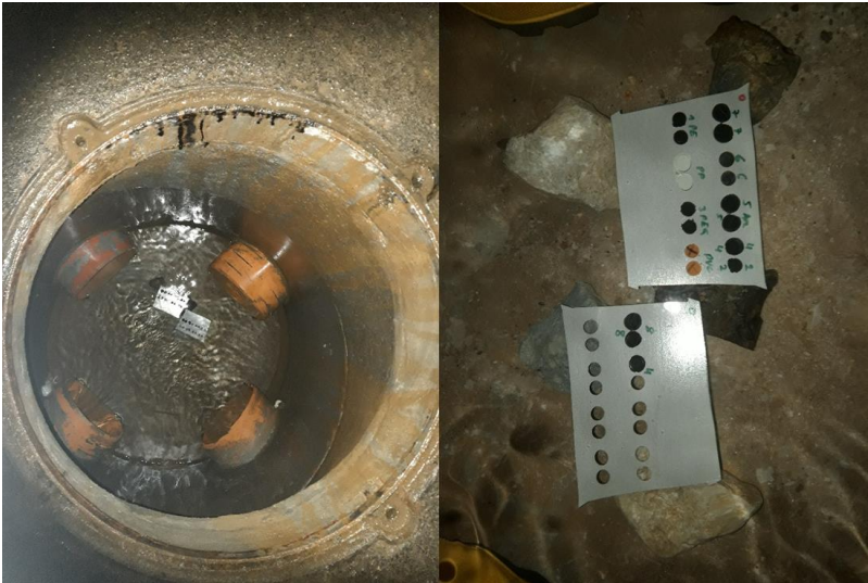
ABB 2. Exemplarische Darstellung der Auslagerung von modifizierten Kunststoffen am Zentrum am Berg [2]
