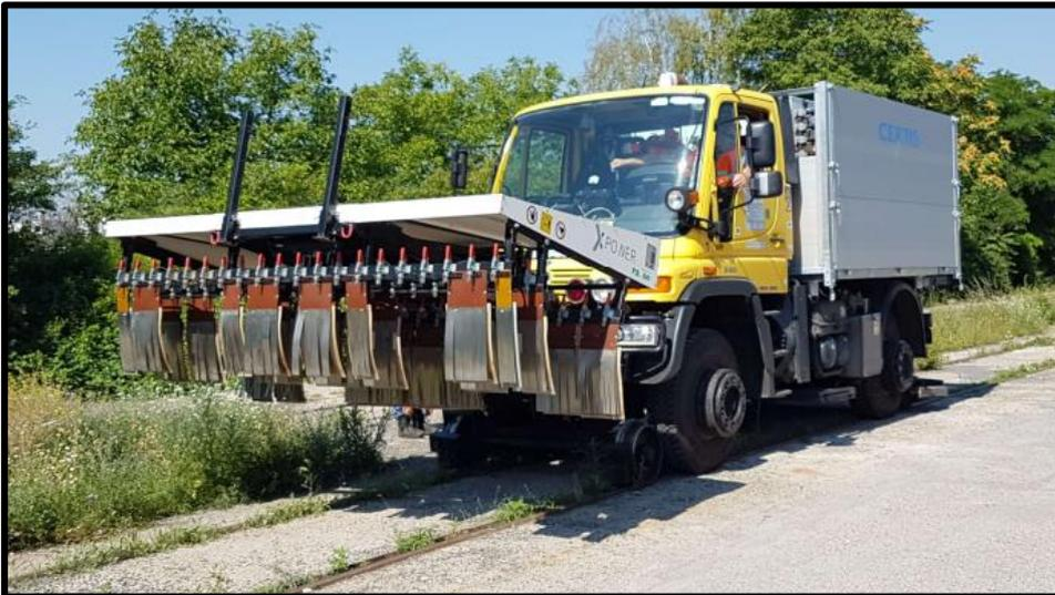
**Abbildung 21: Das von der Firma Certis/Zasso für den Einsatz am Gleis adaptierte Fahrzeug zur Anwendung der Elektroherbizid-Methode auf dem Testgelände in Wien am 23.07.2020.**
