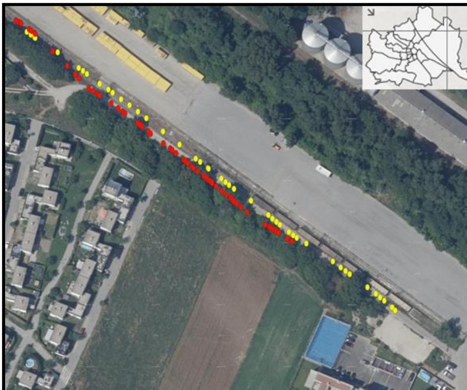
**Abbildung 6: Behandelte Flächen mit Elektroherbizid in Wien Breitenlee, Verschiebebahnhof Oleandergasse im Jahr 2020. Rot dargestellt ist die Behandlungsgeschwindigkeit mit 3 km/h, gelb dargestellt ist die Behandlungsgeschwindigkeit mit 6 km/h. Die Daten zeigen in der Lage nicht korrigierte GPS-Punkte der Anwenderfirma Zasso/Certis.** Quelle: Basemap, verändert.
