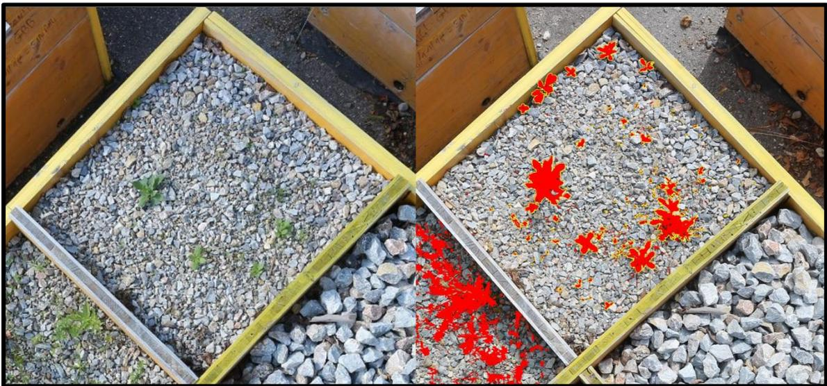
**Abbildung 35: Kalkstein Hollitzer-rein der Testkästen an der FH Kärnten. Links im Bild der Ausschnitt vor Bearbeitung im Programm ImageJ, rechts der bearbeitete Ausschnitt. Die halbautomatische Auswertung erfasst sämtliche Grüntöne (=lebendige Pflanzenteile) im gewählten Ausschnitt. Von den selektierten Flächen lässt sich über das Programm die Blattoberfläche in  $\text{cm}^2$  berechnen.** Quelle: Wiegele (FH Kärnten), verändert
