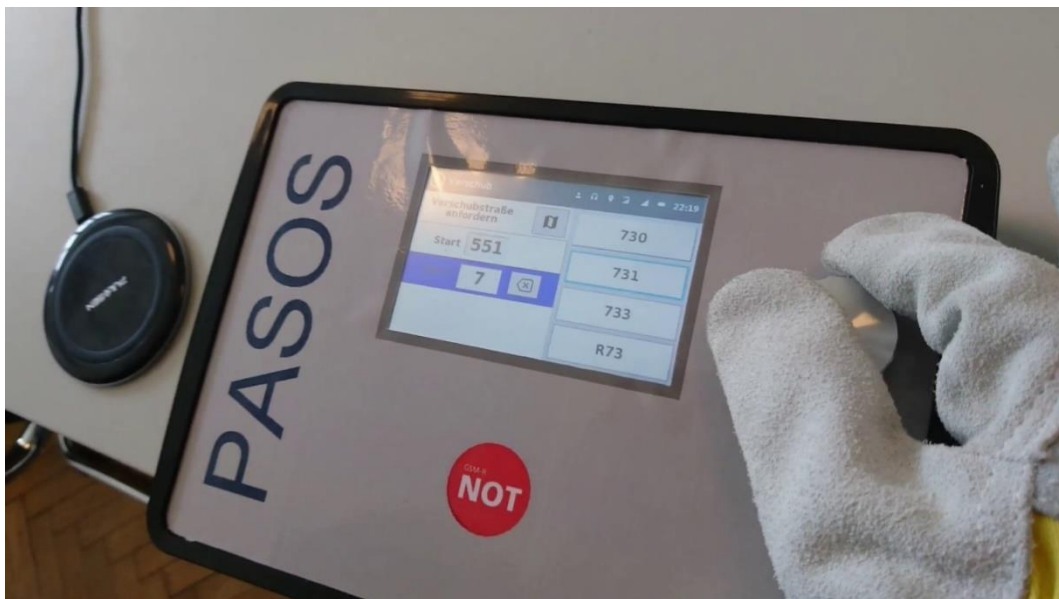
Abbildung 84: Beispielhafte Bedienung mit Handschuhen am Drehrad
