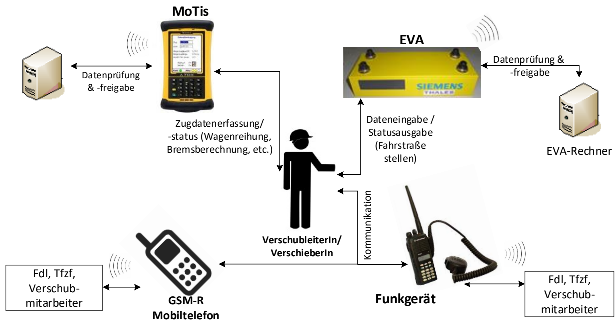
Abbildung 1: Systemübersicht für die im Projekt relevanten Geräte im Verschub
