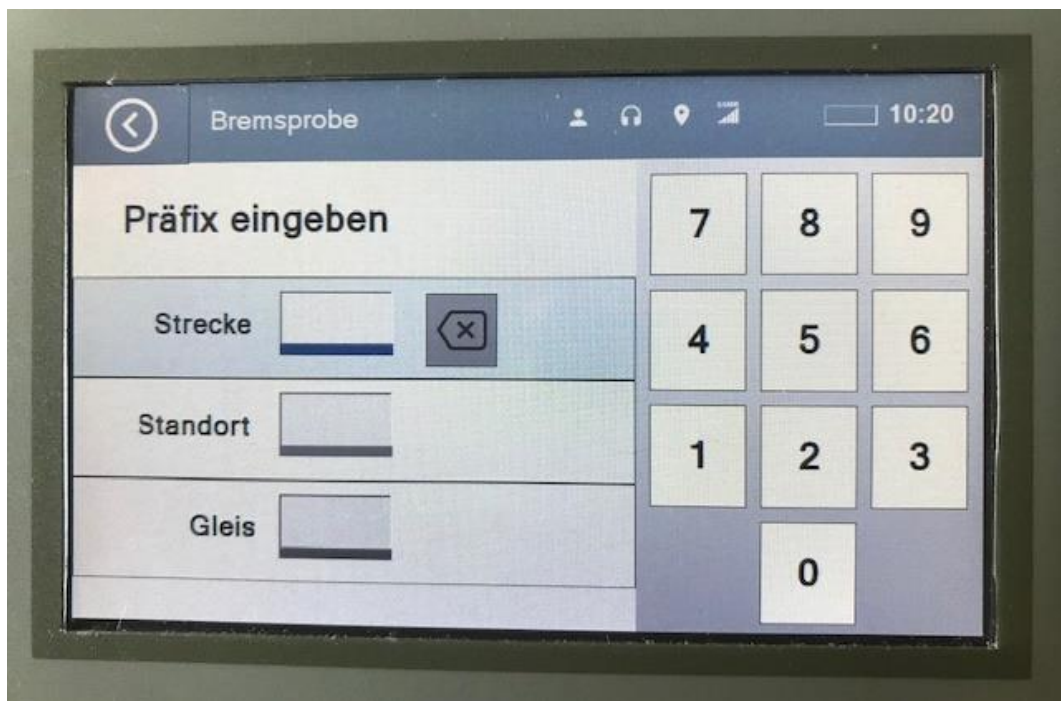
Abbildung 82: Ausführung Bremsprobekörper (via GSM-R)
