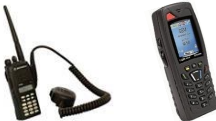
Abbildung 3: Links: Funkgerät, Rechts: GSM-R Mobiltelefon
